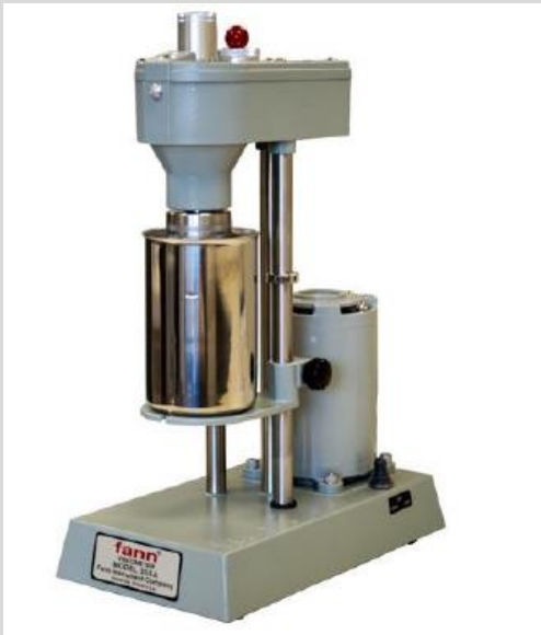
Figura III.2.11.iv.c. Viscosímetro de flujo Couette, Fann 35.
