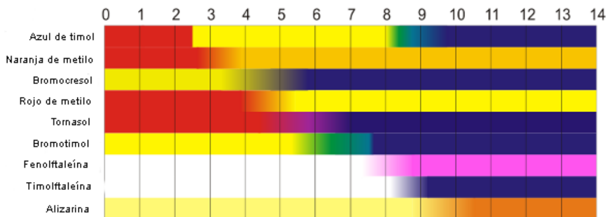
Figura III.2.9.iv.d. Indicadores y el color que adquieren debido a la reacción a diferentes niveles.
