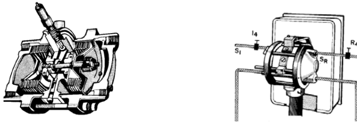
Figura 8.6. Celda diferencial del Registrador de Flujo.
