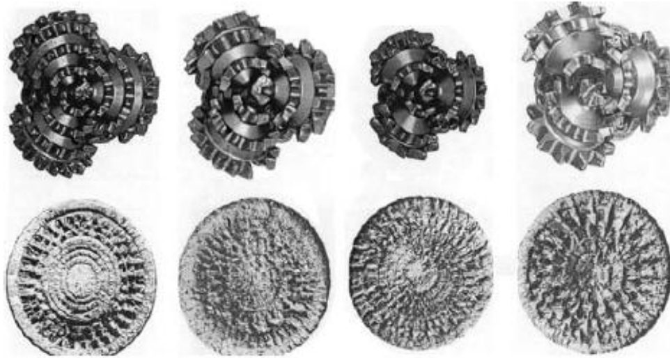
Figura 2.8 Tipos de Huella de la Barrena Tricónica disminuyendo la dureza de la formación de izquierda a derecha.
