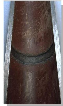
**Figura 4.21.** Poder de remoción del Jetting, muestra la eficacia para remover incrustaciones dentro de las tuberías.
