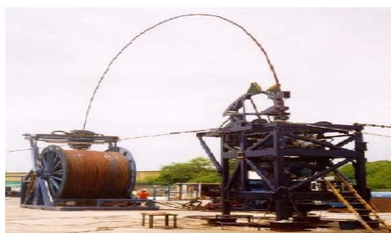
**Figura 2.19. Arco parabólico en la tubería flexible para minimizar el daño por fatiga.**
