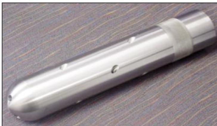
**Figura 5.9. Servicios de limpieza de pozos, boquilla especial que crea un remolino de fluido utilizando ángulos de chorros para eliminar los sólidos a velocidad.**
