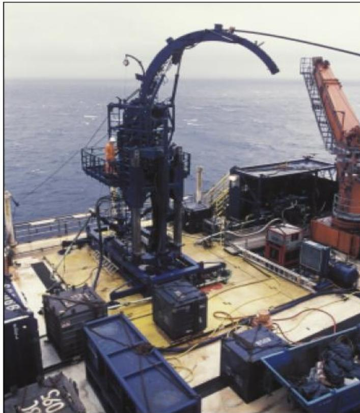
**Figura 5.5. Plataforma del campo Valhall en el sector Noruego del Mar del Norte. Esta unidad “CT SEAS” realiza operaciones de fracturamiento hidráulico con apuntalante.**
