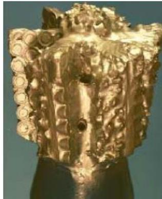
Figura 3.3. Molino para perforar la ventana de re-entrada.
