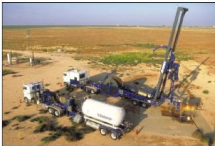
Figura 5.7. Unidad de T.F. terrestre “CT EXPRESS”, incluye dos remolcadores que se montan en menos de 30 minutos, para servicio a pozos.
