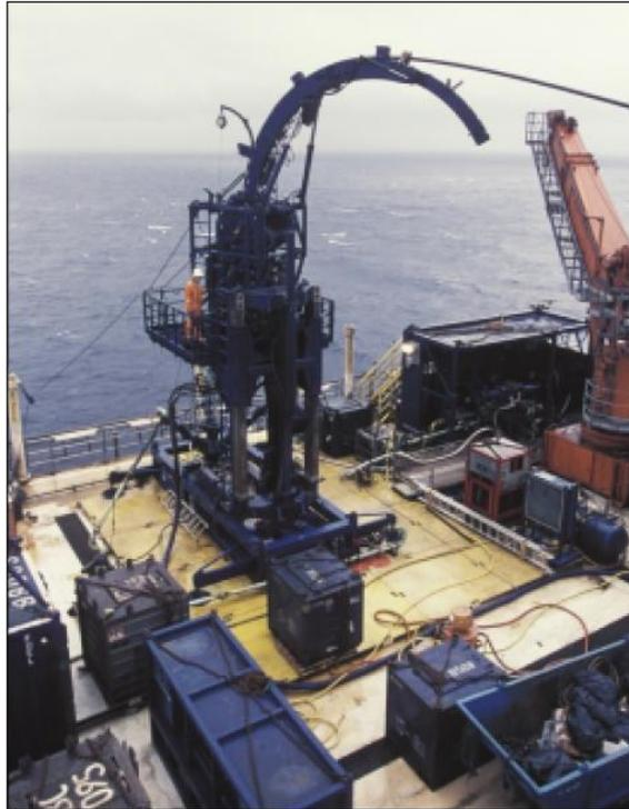
**Figura 3.12. Configuración de la unidad de tubería flexible para operaciones marinas.**
