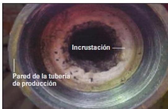
Figura 5.10. Acumulación de incrustaciones en las tuberías del pozo, las cuales reducen el área de flujo.
