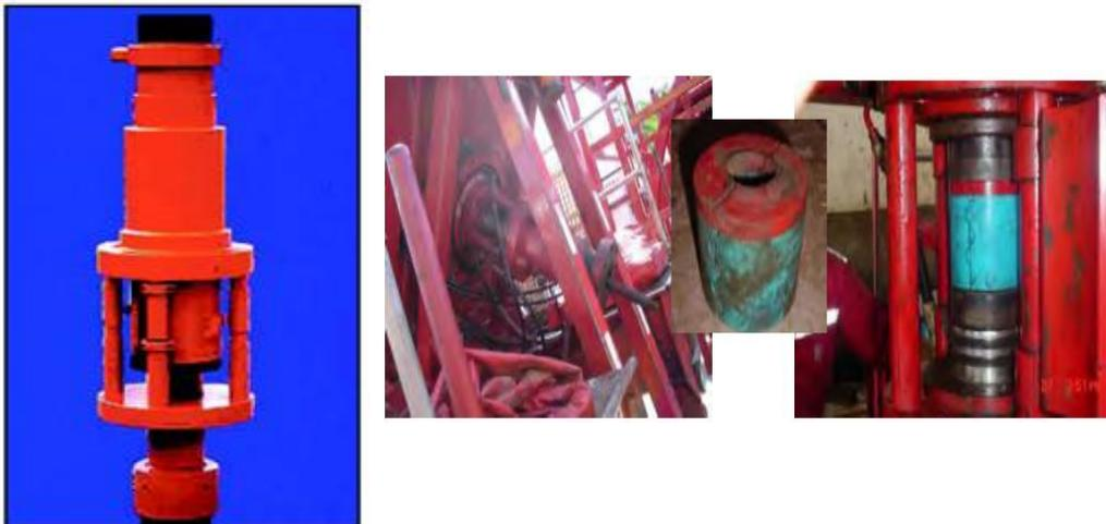
Figura 2.36. De izquierda a derecha: se muestra el cuerpo del estopero y el elastómero.
