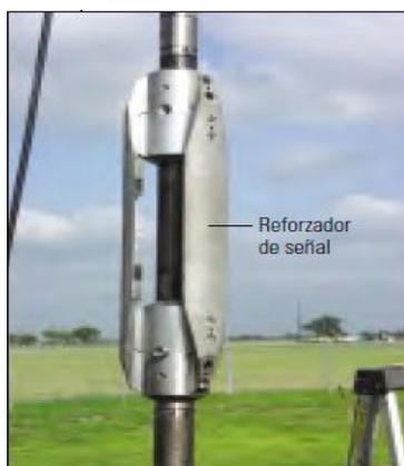
**Figura 5.13. Herramienta de control de la profundidad DepthLOG, la cual ayudo al óptimo posicionamiento del empacador inflable.**
