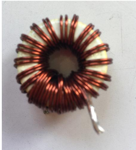
Figura 4. 4 Inductor de salida de la fuente conmutada.
