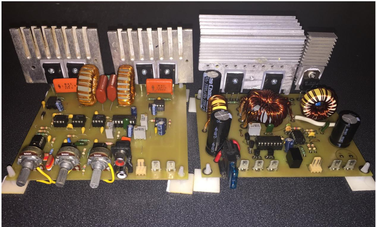
*Figura 5. 1 Circuito impreso del amplificador clase D.*
