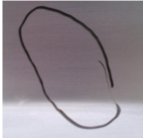
Figura 3.15 Muestra 2 con escurrimiento de zinc dentro del círculo pintado
