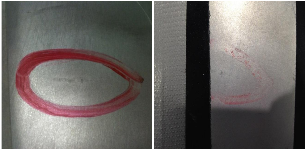
Figura 3.12 Muestra de acero nivel 8 con a) escurrimiento de zinc encerrado en el círculo rojo y b) después de pintar la mitad de la muestra
