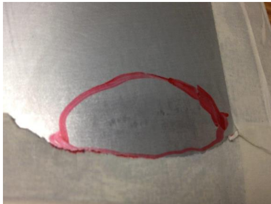
Figura 3.10 Muestra de acero nivel 6 con escurrimiento de zinc encerrado en el círculo rojo
