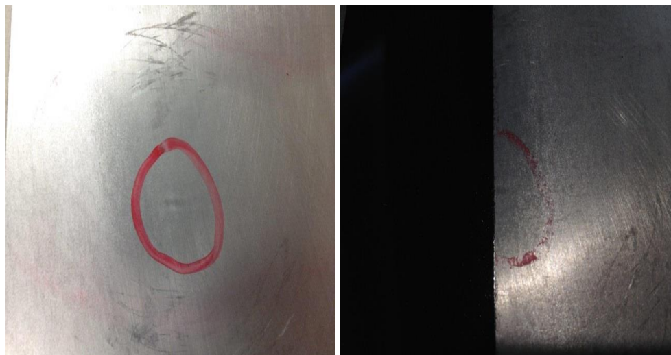
Figura 3.7 Muestra de acero a) nivel 1 y b) nivel 2 con escurrimiento de zinc encerrado en el círculo rojo
