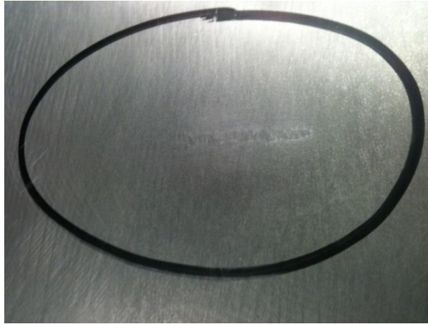
Figura 3.1.-Se observa la condición de escurrimiento de zinc encontrada en una salpicadera
