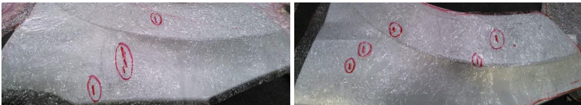
Figura 3.25 a)Muestra 49 y b)muestra 47 den fase 4, la plantilla indica la posición de escurrimiento de zinc
