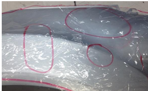
Figura 3.21 Muestra 6 con escurrimiento de zinc dentro del círculo pintado y plantilla plástica representando las zonas donde se encuentra la condición
