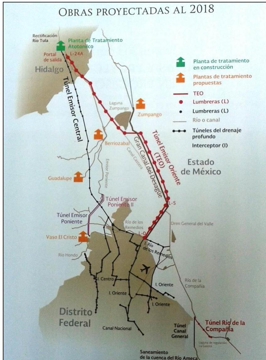
Figura 02. Croquis general del sistema de drenaje y desagüe de la ciudad de México <sup>(2)</sup>.
