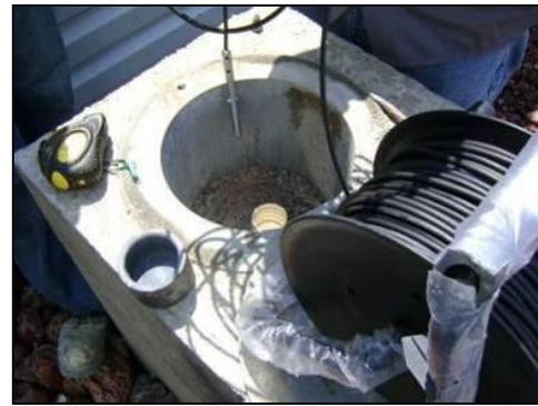
**FOTOGRAFIA 15.** Monitoreo de tubo de observación con sonda piezométrica (sonda acústica).
