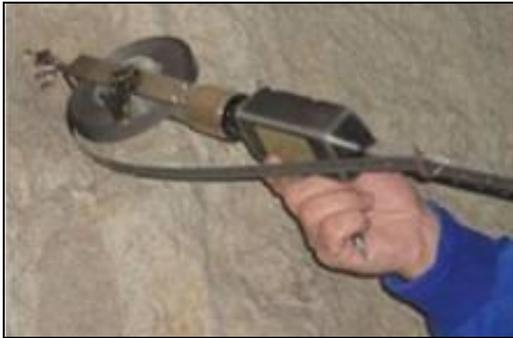
FIGURA 05. Medición de convergencias con extensómetro <sup>(3)</sup>.
