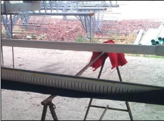
**FOTOGRAFIA 12.** Tubería ranurada utilizada para la instalación de un tubo de observación a 145m de profundidad.
