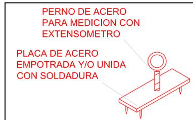
Figura 03. Esquema de colocación de armella (punto fijo de control) para la medición de convergencias en la Lumbraera.
