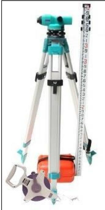
FIGURA 08 Nivel electrónico <sup>(5)</sup>.
