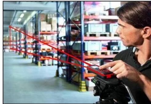
FIGURA 06. Ejemplo de medición con distanciómetro laser <sup>(4)</sup>.
