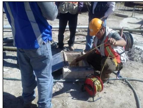
**FOTOGRAFIA 08.** Monitoreo de piezómetro abierto.
