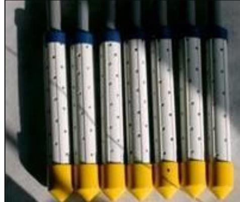
**FIGURA 17.** Cámara piezométrica y/o bulbo de línea <sup>(9)</sup>.
