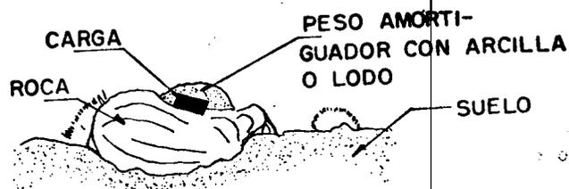
Fig. 80 Método de la carga externa
