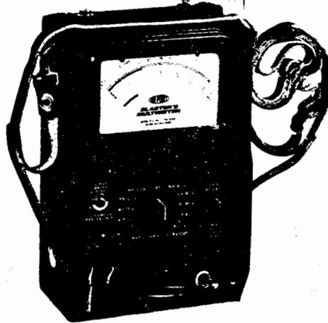
Fig.17 Multímetro para voladuras.
