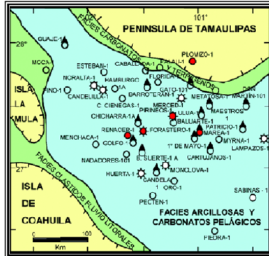
FIGURA 3.24 Distribución de facies de la Formación Menchaca (Berriasiano), como roca sello para los plays La Casita (Tomada de Eguiluz, 2007).
