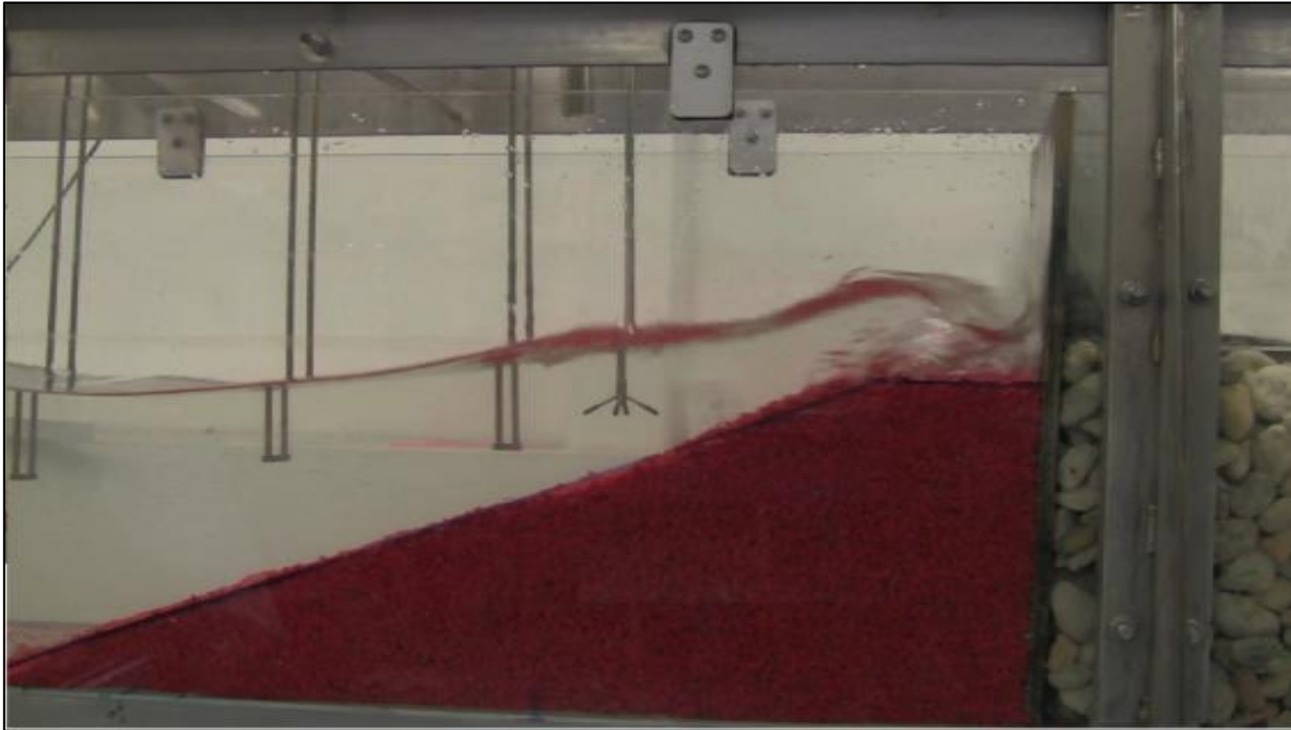
Figura 5.5 Instante en que se presenta la socavación máxima producto de la rotura del oleaje focalizado frente al muro marino vertical sobre el talud construido con el material tipo 2, D_{50} = 3.60 mm.
