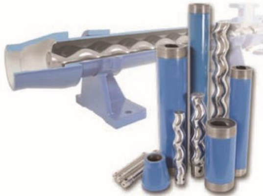
Figura 2.6 Bomba de cavidades progresivas utilizadas para la elaboración de alimentos. Un corte muestra el rotor de acero posicionado con el estator elastomérico fijo adherido a la carcasa de acero. Cortesía de Shanley bombas y equipo.
