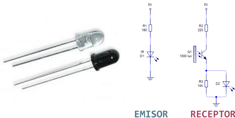
FIGURA 34 LED INFRARROJO Y FOTODIODO CON SU DIAGRAMA DE CONEXIÓN. RECUPERADO DE: WWW.CIRCUITOSELECTRONICOS.ORG Y WWW.FOROSDEELECTRONICA.COM
