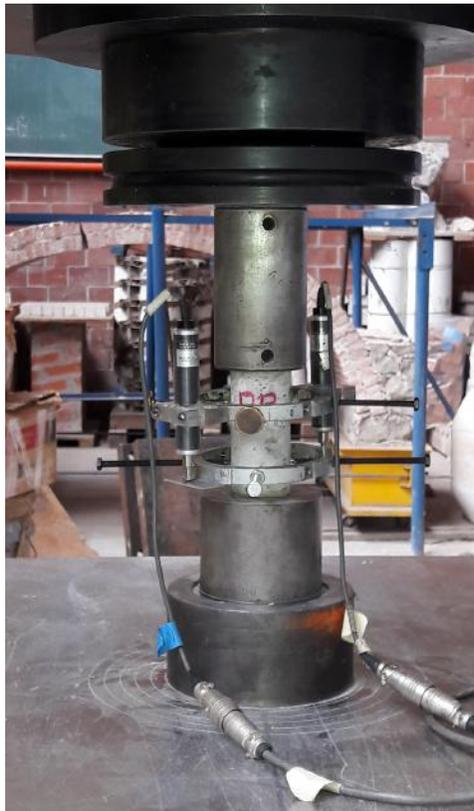
*Figura 15: Espécimen listo para ser ensayado.*
