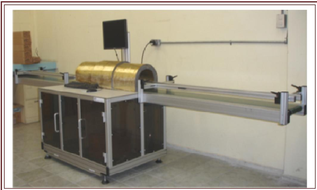
FIGURA 5.29. Equipo de laboratorio para la obtención de la radiactividad natural de núcleos (Martell, 2008).
