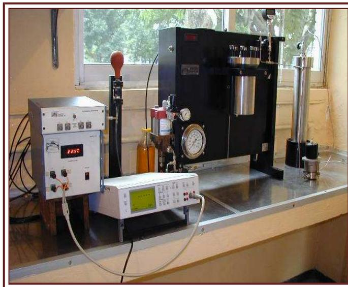
FIGURA 2.34. Resistímetro (Martell, 2008).
