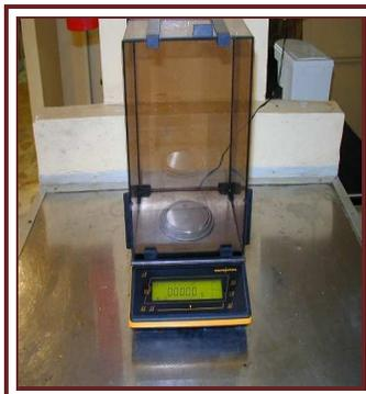
FIGURA 2.23. Pesado de muestras mediante báscula electrónica (Martell,2008).
