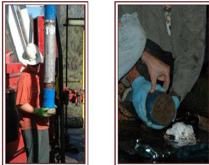
FIGURA 2.2. Barrena con el barril (izquierda) y la corona se desprende (derecha) al final alcanzando la profundidad total deseada para obtener el núcleo (Tomada de <http://www.icdp-online.de/sites/sanandreas/news/news1.html>, 2009).
