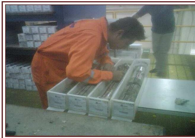
FIGURA 2.38. Proceso de limpieza de núcleos de roca para realizar el inventario (Pemex, 2008).
