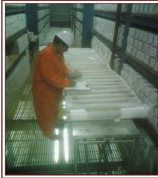
FIGURA 2.37. Fotografía que muestra como se manipulan cajas que contienen los núcleos obtenidos en el pozo durante el proceso de inventario (Pemex, 2008).
