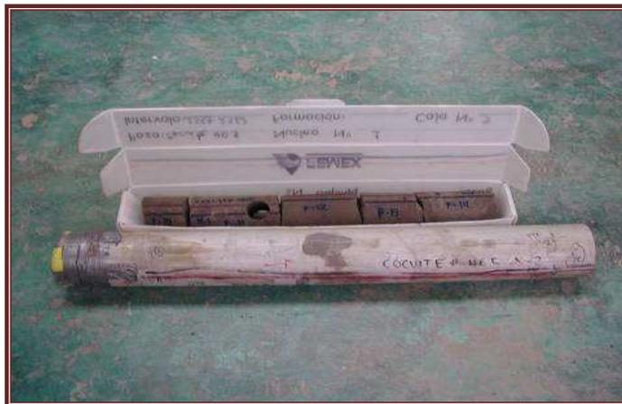
FIGURA 2.4. Ejemplo de un núcleo orientado y guardado en forma adecuada (Pemex, 2008).
