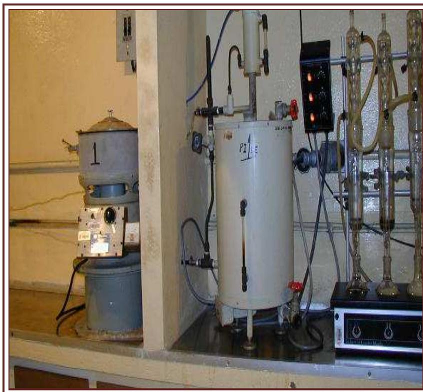
FIGURA 2.21. Limpieza de núcleos por centrifuga (Martell, 2008).
