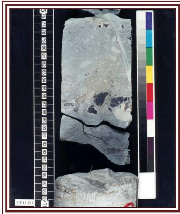
FIGURA 5.33. Fotografía que muestra fragmentos de núcleos de roca extraídos de un pozo de la Sonda de Campeche, con luz natural (Core Lab archivo técnico inédito, 2008).
