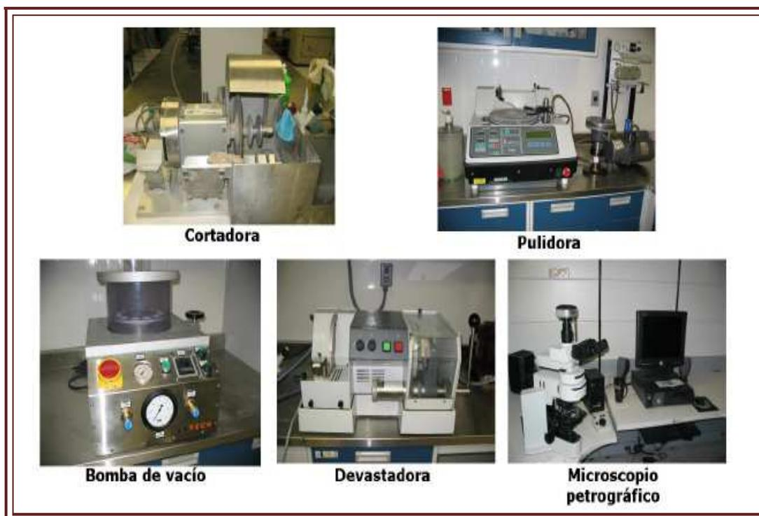
FIGURA 2.26. Equipo para análisis para estudios petrográficos y sedimentológicos en muestras en laboratorio (Martell Andrade, 2008).
