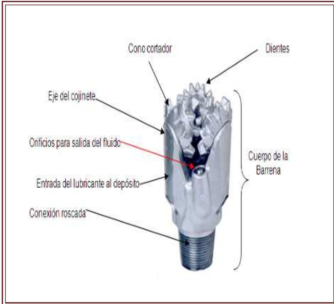
FIGURA 2.9. Barrena tricónica que se utiliza en la perforación de pozos petroleros convencionales (Pemex UPMP, 2003).
