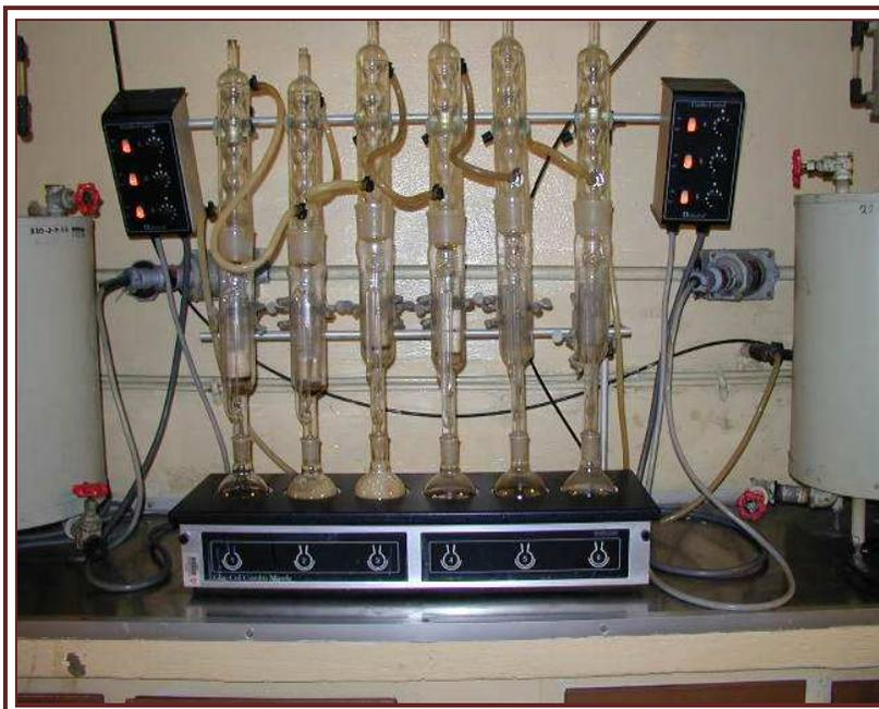
FIGURA 2.20. Limpieza de núcleos por método Soxhlet (Martell,2008).
