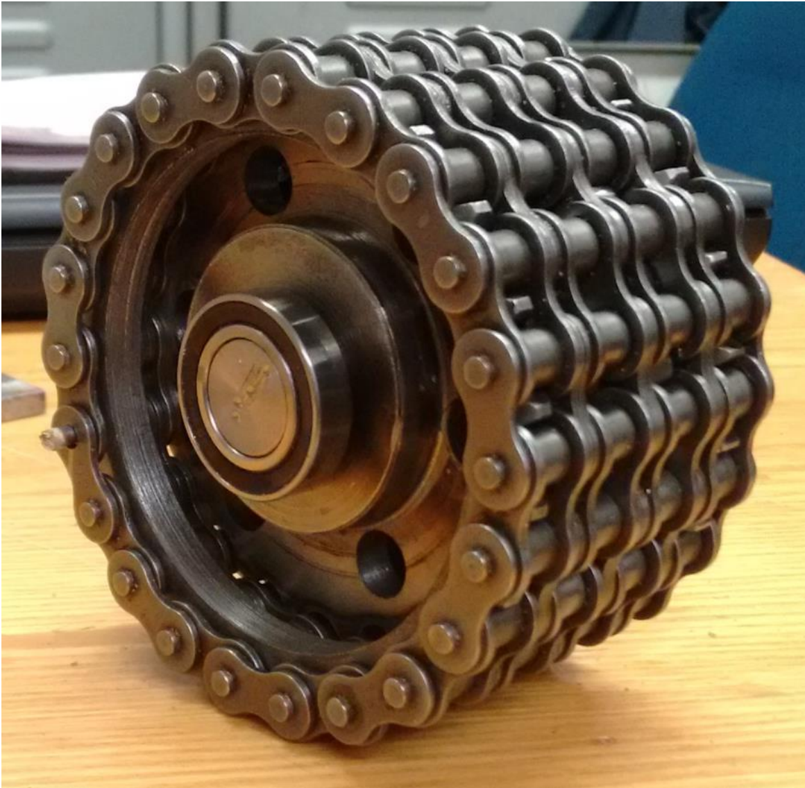
Figura 4.3. Arreglo de sprockets y cadena de rodillos cerrado
