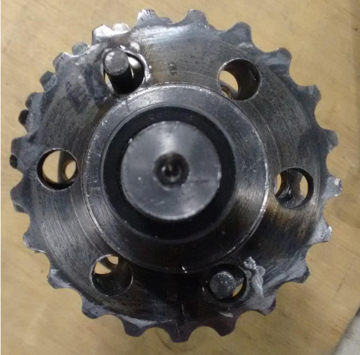
Figura 4.4. Inserción de los pernos de arrastre, pasando entre los dos Sprockets 40B21
