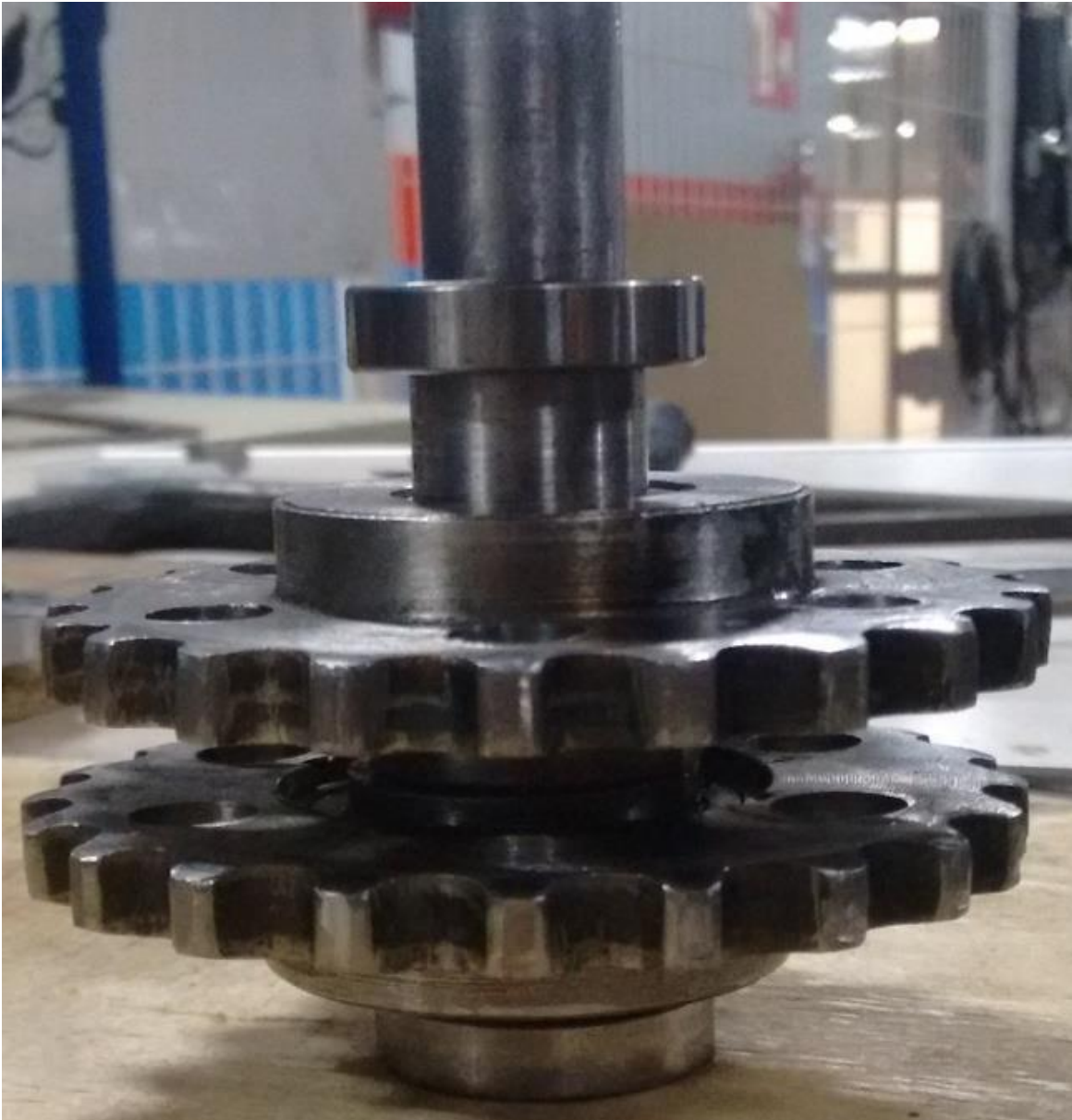
Figura 4.1. Ensamble de Sprockets 40B21 y rodamientos sobre la flecha excéntrica
