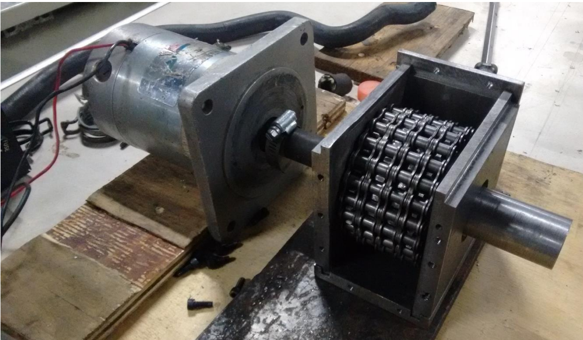
Figura 4.8. RVC conectado a motor eléctrico
