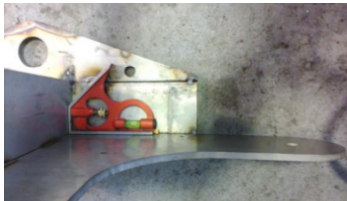
Figura 5.14: Escuadra para nivelarlo. (Cortesía de [23])
