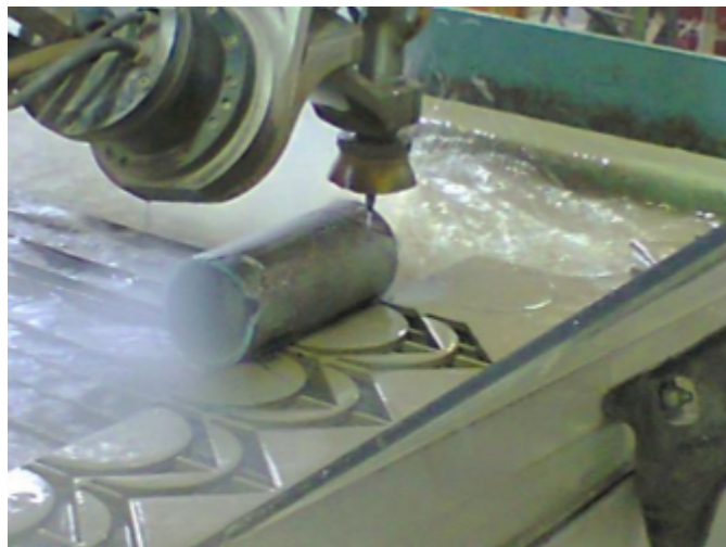
Figura 5.95: Corte de los toldos por máquina de chorro de agua. (Cortesía de [23])
