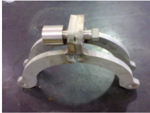
Figura 5.70: Mordazas con seguro para asegurar el tubo. (Cortesía de [23])
