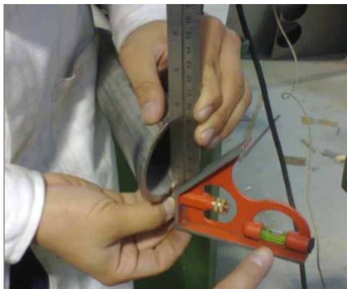
Figura 5.24: Verificando el ángulo con nivel. (Cortesía de [23])
