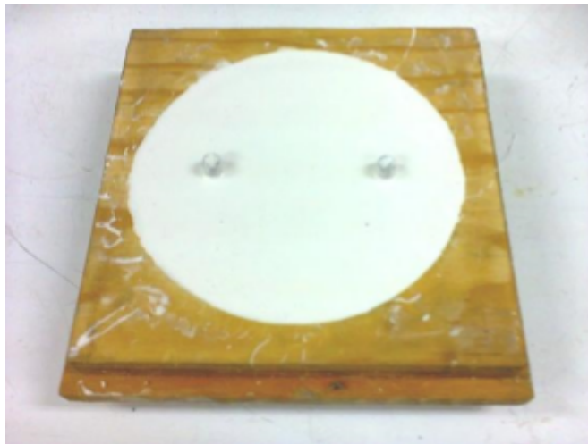
Figura 5.76: Colocación del alma de la tapa con la mezcla del silicón en el molde. (Cortesía de [23])
