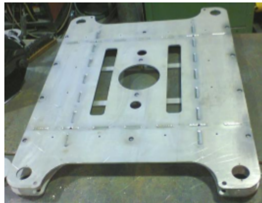
Figura 5.44: Soldadura terminada de la placa de pesas. (Cortesía de [23])
