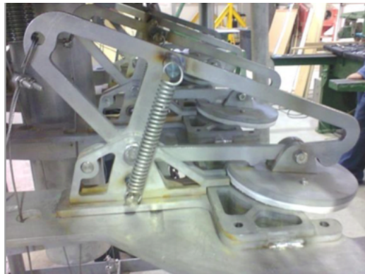
Figura 7.4: Resortes del sistema de cierre superior.
