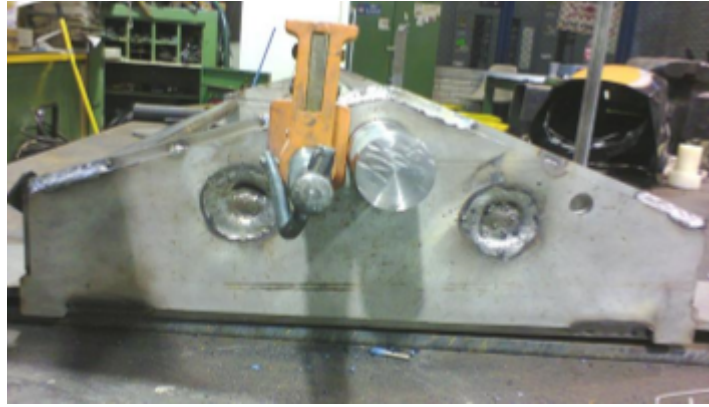
Figura 5.13: Placa de Soporte Guiada ahora Soldada. (Cortesía de [23])
