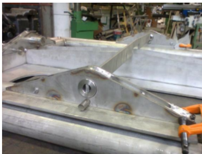
Figura 5.34: Barra lateral para el alineado.
