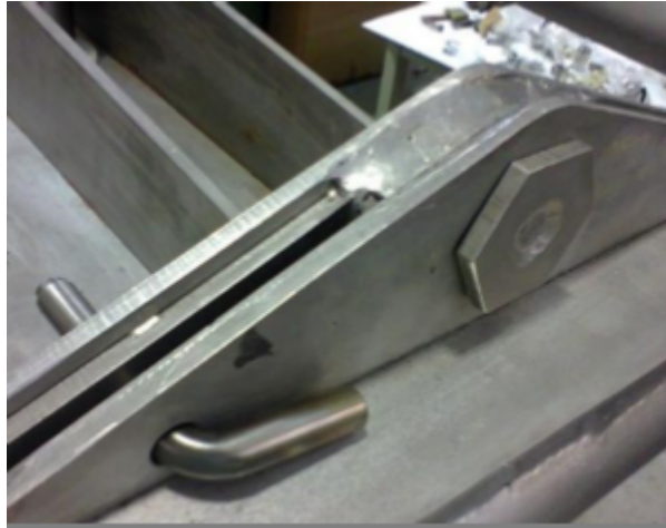
Figura 5.32: Colocación de pernos de seguridad. (Cortesía de [23])
