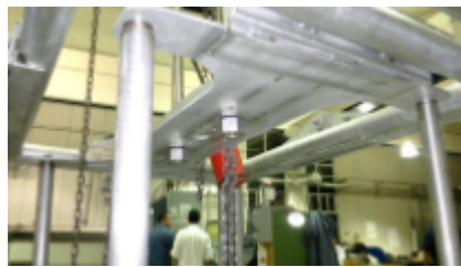
Figura 6.18: Vista inferior de la placa superior con las cuatro guías.
