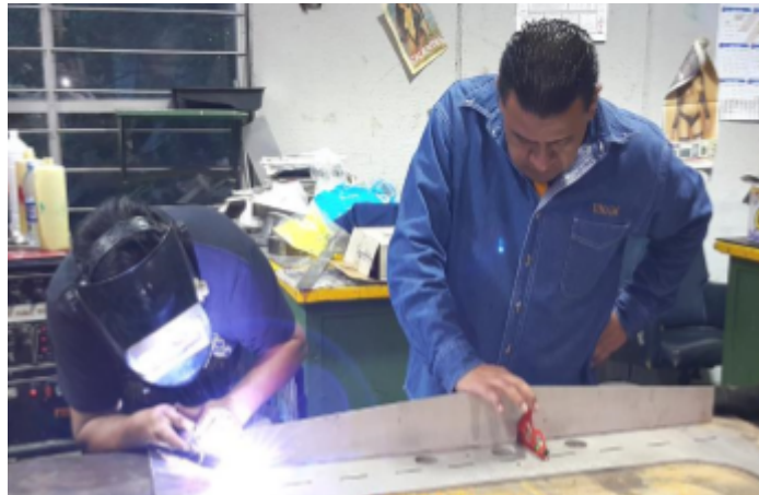
Figura 5.4: Soldando el ala. (Cortesía de [23])
