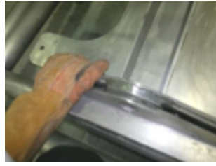
Figura 6.11: Empate de los soportes de sujeción-límite de la placa superior con los soportes del marco auxiliar. (Cortesía de [22])
