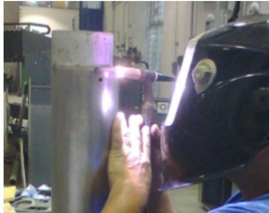
Figura 5.57: Soldado de la tapa al tubo con soldadura TIG.
