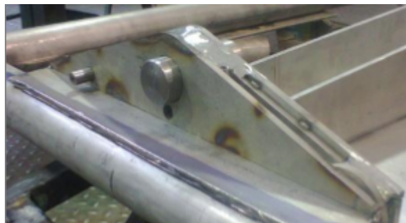
Figura 5.31: Soporte recortado sin material sobrante.
