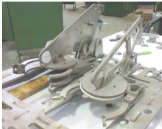
Figura 5.67: Versiones del mecanismo de cierre de los tubos.
