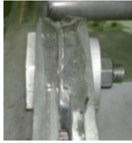
Figura 6.8: Pernos con arandela y tuerca en las orejas. (Cortesía de [22])
