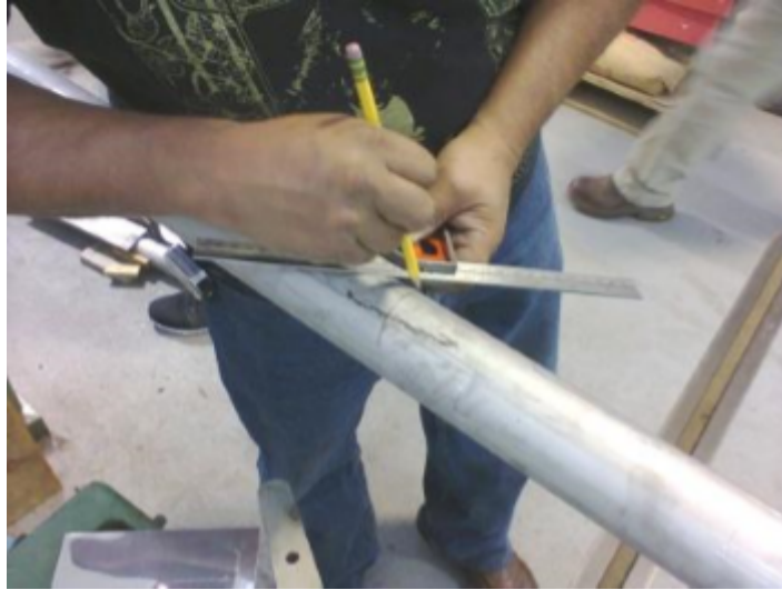
Figura 5.21: Se cortan los tubos a 45 grados. (Cortesía de [23])
