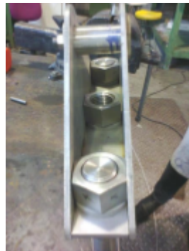
Figura 6.3: Guías con arandelas y tuercas.
