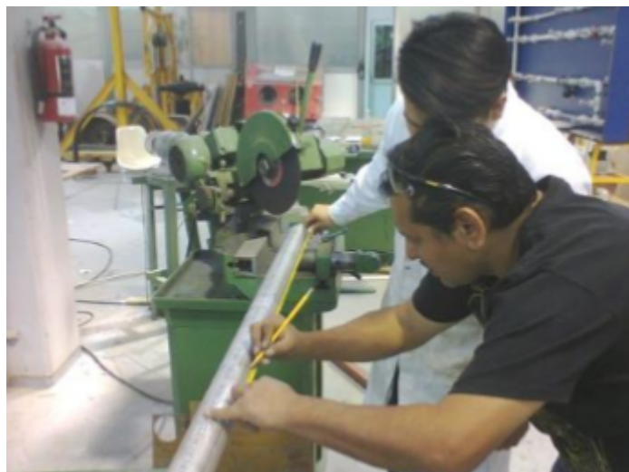
Figura 5.20: Se miden tubos para el corte. (Cortesía de [23])
