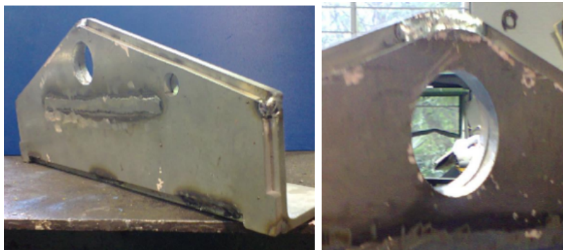
(a) Placa deformada al intentar soldarlo. (b) Barreno deformado no concéntricos.
