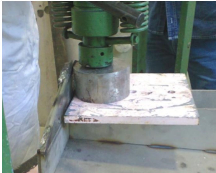
Figura 5.16: Enderezando placas con prensa.
