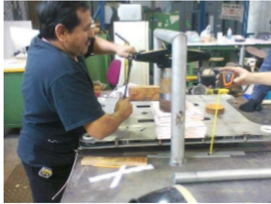
Figura 5.46: Enderezamiento de la placa de pesas.
