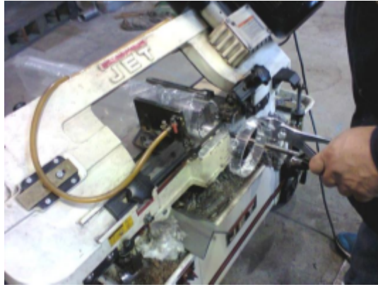
Figura 5.72: Corte de los tubos de policarbonato.
