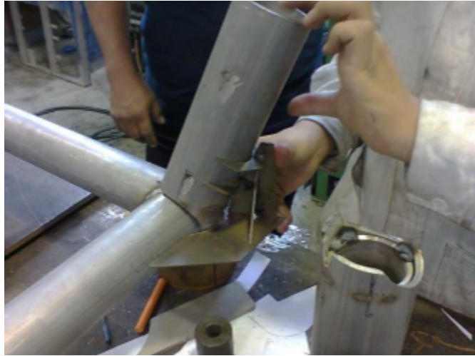
Figura 5.98: Escantillón, pieza auxiliar para el soldado de los toldos al marco exterior. (Cortesía de [23])
