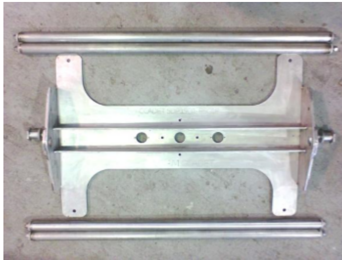
Figura 5.19: Placa superior y guías de estructura externa terminada. (Cortesía de [23])
