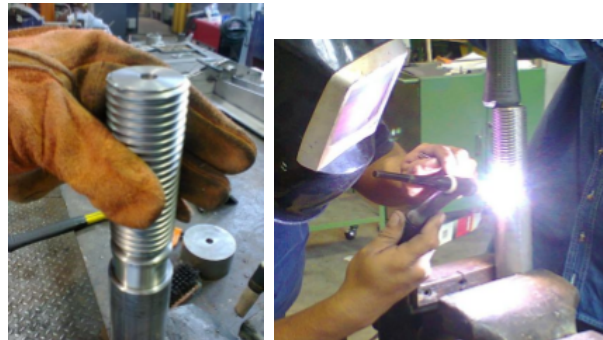
(a) Vástago dentro del émbolo. (b) Soldadura del vástago con el tubo (émbolo).
