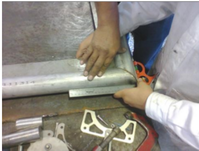
Figura 5.25: Se miden uniones para que tengan 90 grados. (Cortesía de [23])
