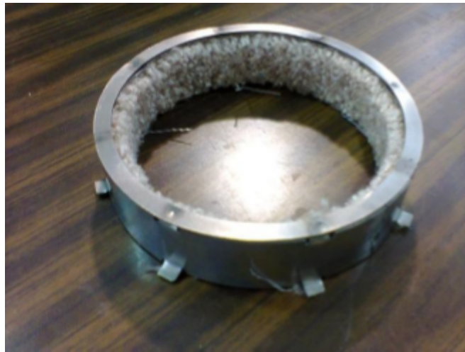
Figura 5.88: Felpa con el guarda felpa (aro). (Cortesía de [23])
