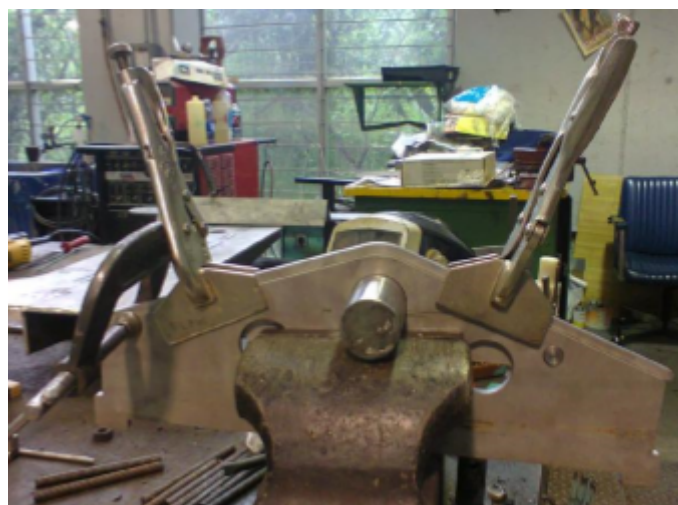
Figura 5.10: Sujeción de soporte de placa para soldarse.
