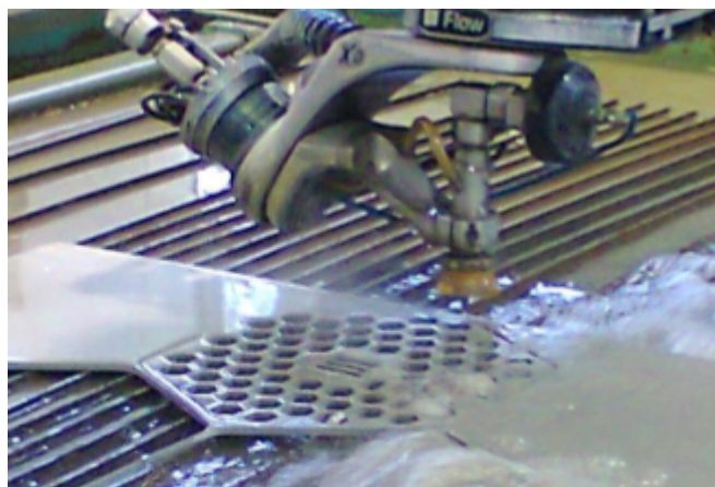
Figura 5.91: Corte de las raquetas en la máquina de corte por chorro de agua. (Cortesía de [23])
