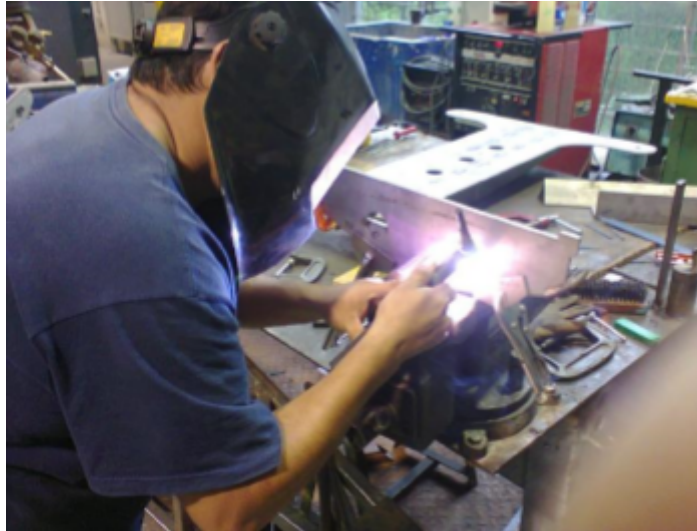
Figura 5.11: Placa sujeta soldada.
