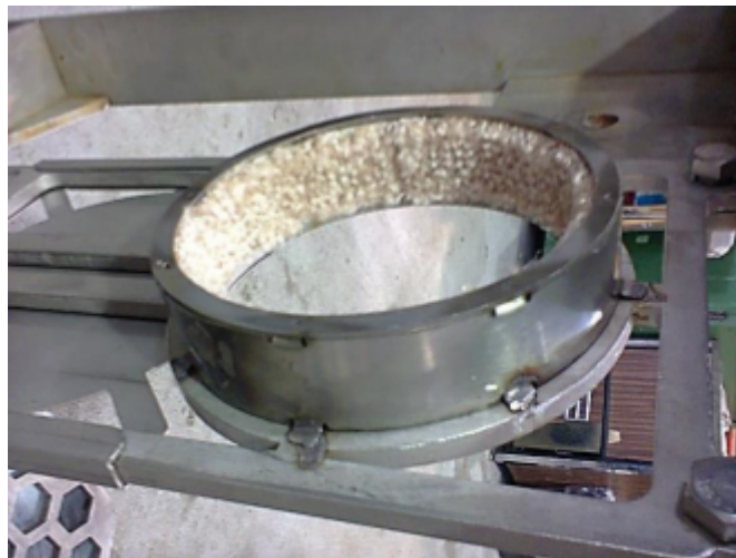
Figura 5.89: Guarda felpa punteada al marco de guillotinas. (Cortesía de [23])
