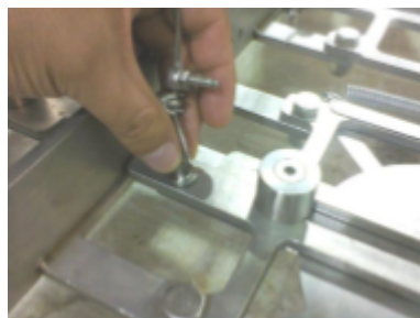
Figura 6.32: Colocación del seguro de la guillotina.
