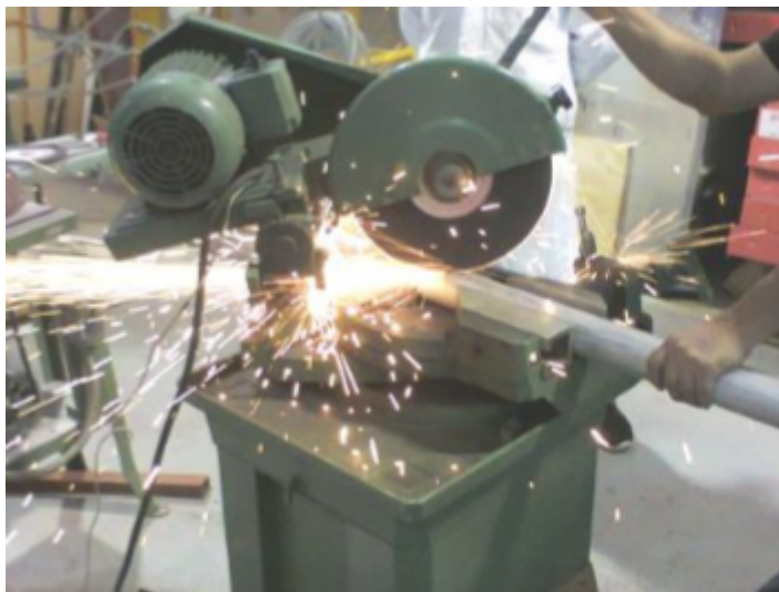
Figura 5.22: Corte de tubos a 45 grados. (Cortesía de [23])
