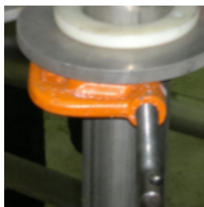
Figura 6.27: Prensa para asegurar la placa de tubos durante el ensamble.
