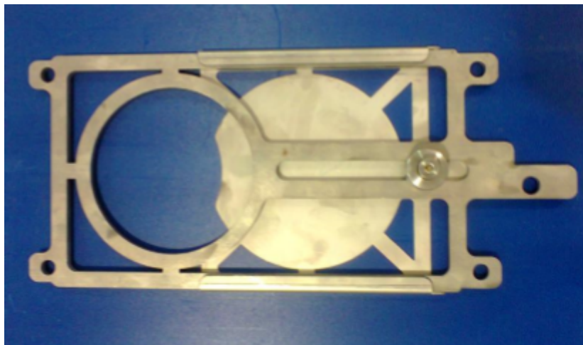
Figura 5.85: Placa de guillotina con envolvente doblada sobre el marco. (Cortesía de [23])
