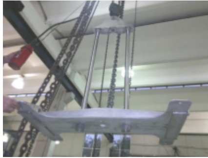
Figura 6.5: Ensamblaje de la placa superior con el yugo y guías. (Cortesía de [22])
