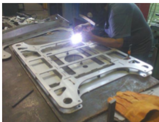
Figura 5.42: Soldadura de los largueros con la placa inferior de la placa de pesas. (Cortesía de [23])
