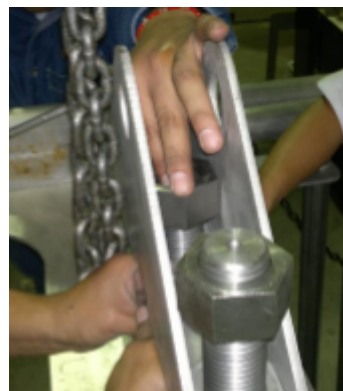
Figura 6.24: Inserción del émbolo en el yugo con tuerca inferior y superior. (Cortesía de [22])
