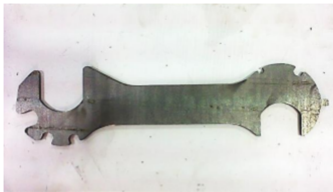
Figura 5.105: Llave para tuercas usadas en el multinucleador. (Cortesía de [23])
