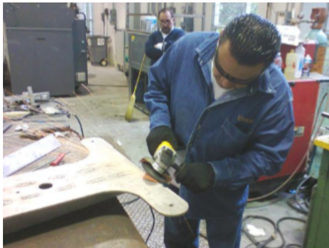
Figura 5.6: Esmerilado de la placa superior.
