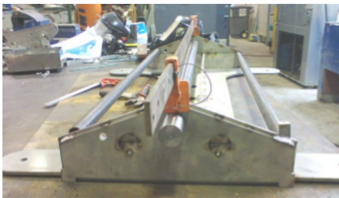
Figura 5.12: Placa con guías para alinearse.
