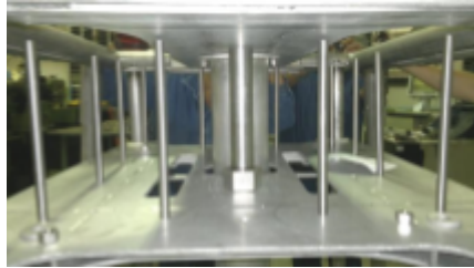
Figura 6.25: Placa de pesas con las guías para las pesas.
