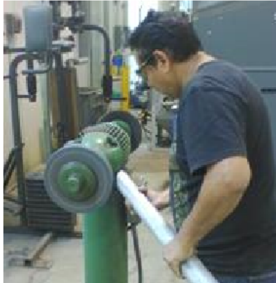
Figura 5.23: Esmerilado de tubos. (Cortesía de [23])
