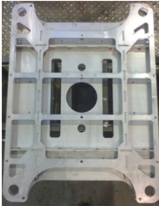
Figura 5.41: Placa de pesas inferior sobre los largueros. (Cortesía de [23])
