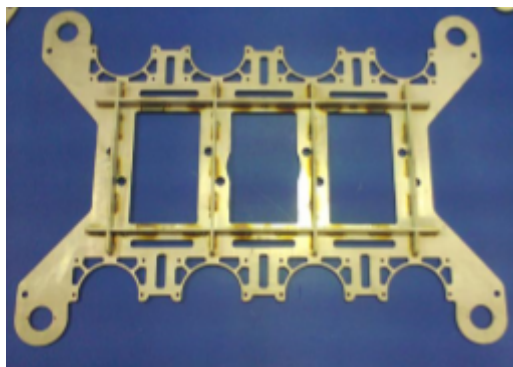
Figura 5.65: Largueros y travesaños sobrepuestos en la placa de tubos.
