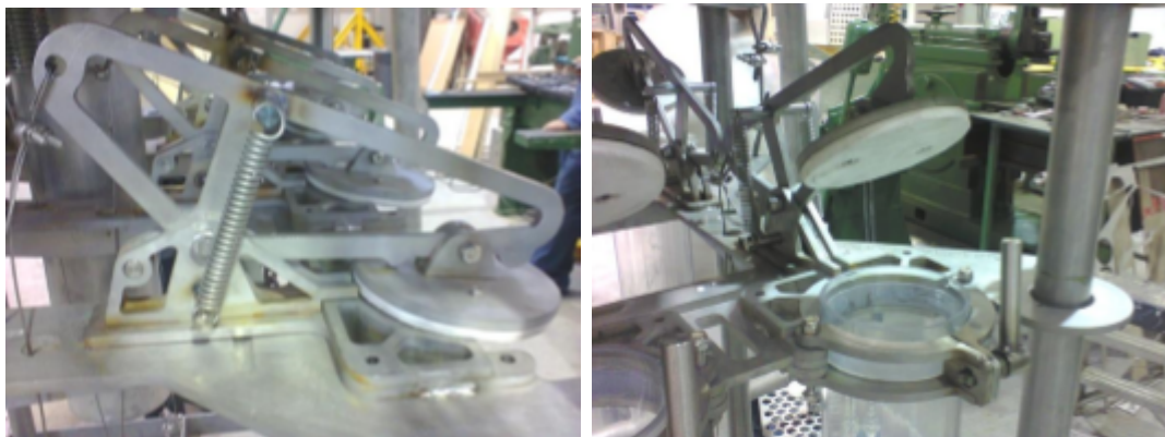
(a) Vista lateral del mecanismo de cierre superior. (b) Mecanismo de cierre instalado en la placa de tubos.
