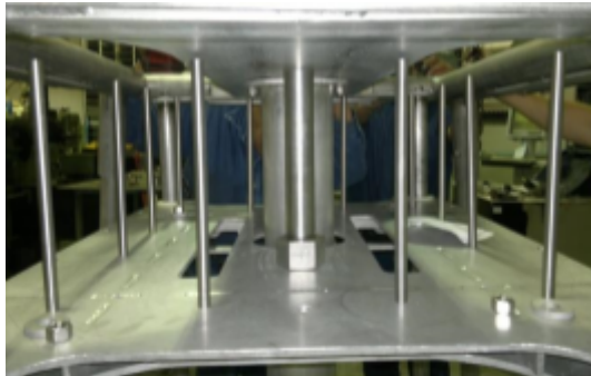
Figura 5.49: Guías colocadas en la placa de pesas.
