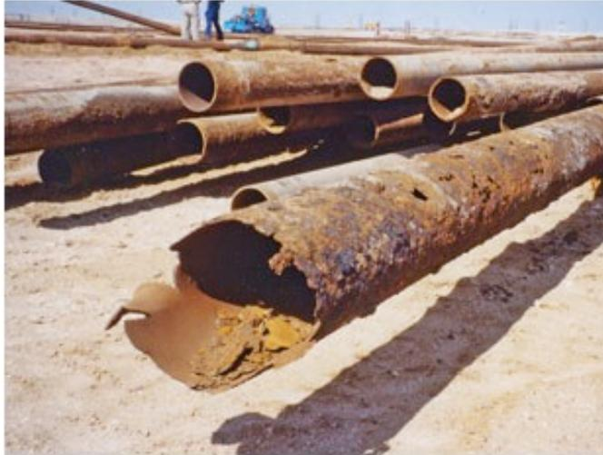
**Figura 15. Tuberías de perforación destruidas por la corrosión.**
