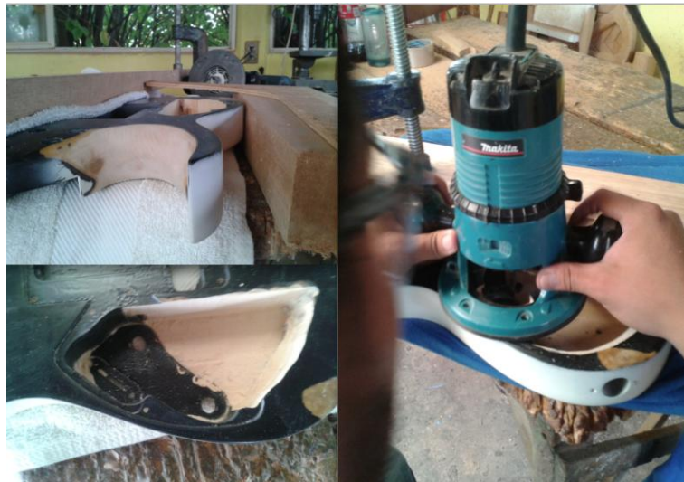
Figura No. 3.15: Ampliación de la cavidad Referencia: Archivo fotográfico del proyecto
