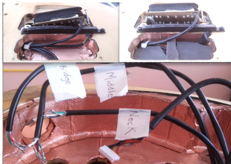
Figura No. 3.19: Sistema Roland instalado A Referencia: Archivo fotográfico del proyecto
