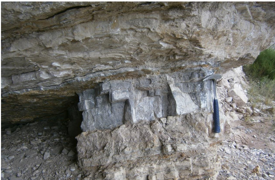
Manto de Fosforita en una estructura mineralizada de geometría estratiforme.
