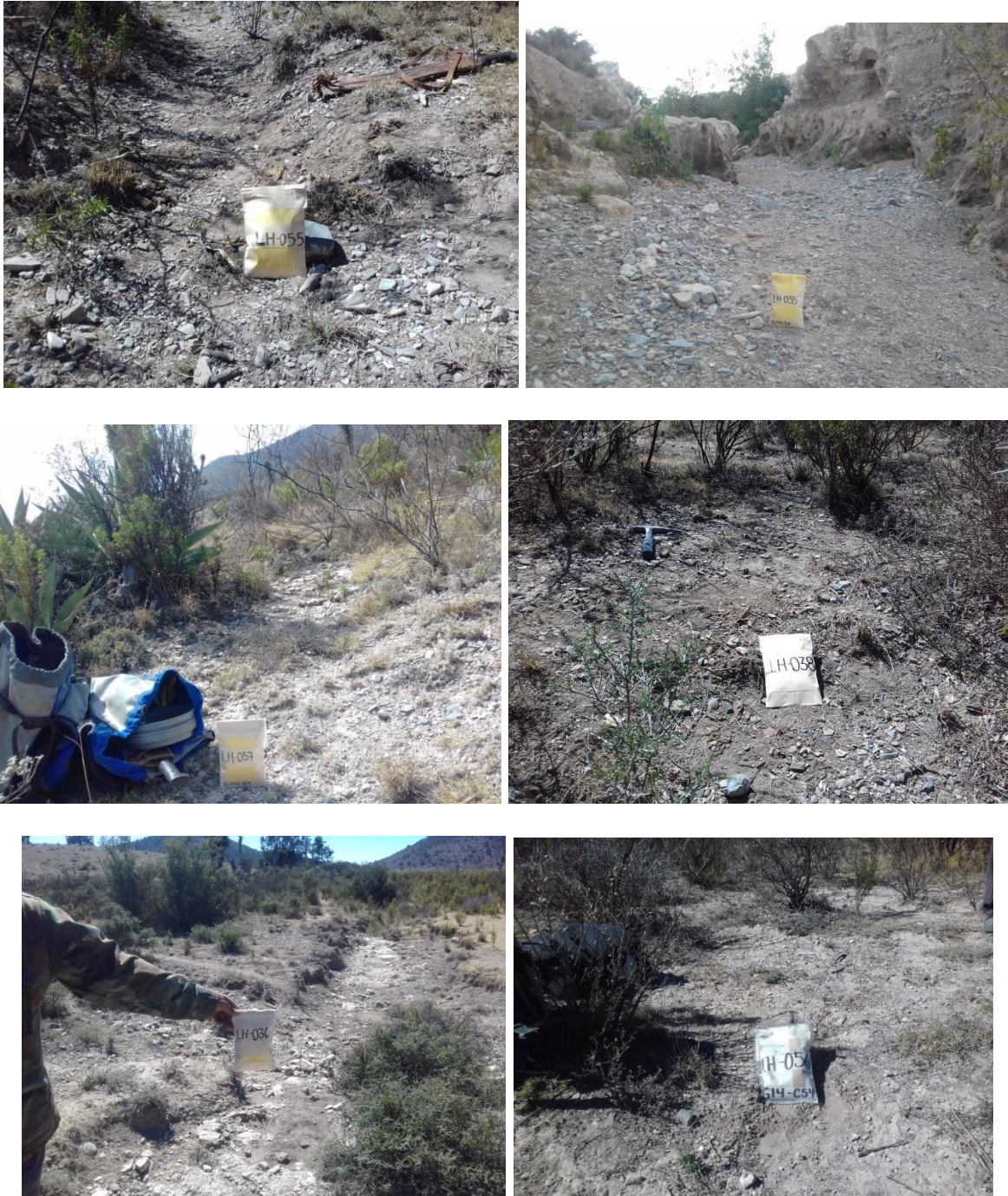
Figura #20. Conjunto de afloramientos en donde se pueden observar algunos de los puntos de muestreo de sedimento de arroyo activo. En las imágenes se aprecian diferentes puntos de control de dicho muestreo geoquímico, donde los datos recabados fueron ingresados directamente al Mapamovil del SGM. La mayoría de las veces se describían sedimentos de coluvión y de aluvión.
