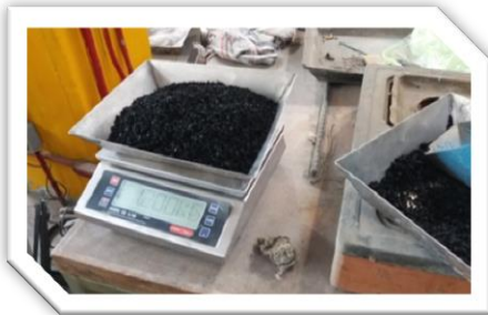
Fig. 5.26.- Dosificación del caucho en granulo.
