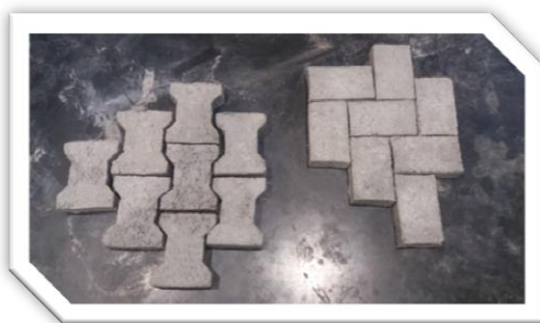
Fig. 5.29.- Preparación de las piezas para ser ingresadas a la cámara de curado.
