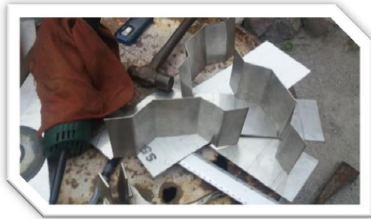
Fig. 5.2.- Cortado y doblado de las piezas, se utilizó lámina de acero inoxidable.
