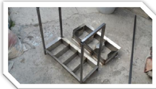
Fig. 5.5.- Presentación de los marcos que soportaran las placas.
