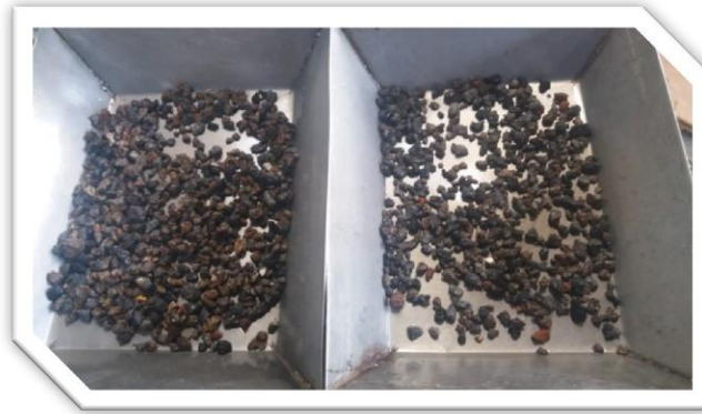
Fig. 3.13.- Después de lavar el agregado grueso a fin de eliminar los residuos de ácido muriático y mortero, se puede observar claramente los distintos tipos de material que convergen en la trituración de los residuos de la construcción.
