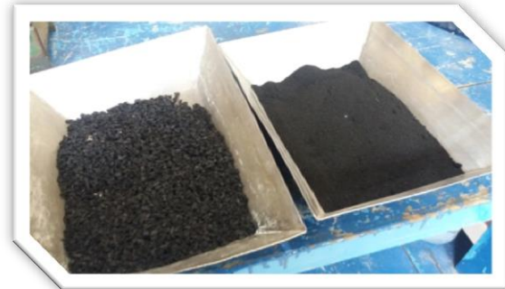
Fig. 5.24.- Del lado izquierdo se observa el caucho en granulo cuyo tamaño oscila entre 3 y 5mm y del lado izquierdo el caucho en polvo.
