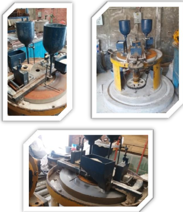
Fig. 6.13.- Diferentes vistas de la máquina con que se cuenta en el laboratorio de construcción de la Facultad de Ingeniería para realizar la prueba de resistencia a la abrasión.
