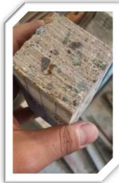
Fig. 6.22.- Desgaste que presentan las probetas después del ensaye.
