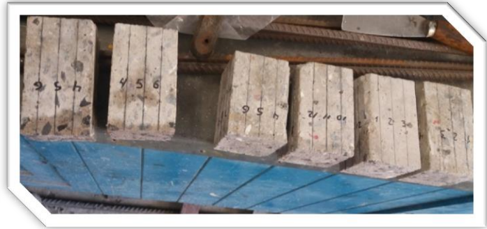
Fig. 6.23.- Comparación del desgaste que presentaron diversos especímenes.
