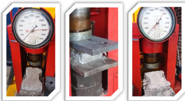
Fig. 6.5.- Resistencia a compresión de distintos adoquines, figura de hueso.
