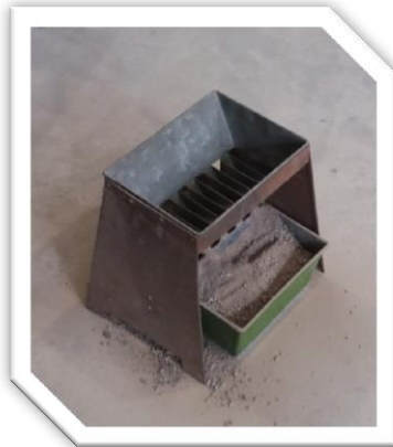
Fig. 3.4.- Cuarteo mecánico de los agregados reciclados.
