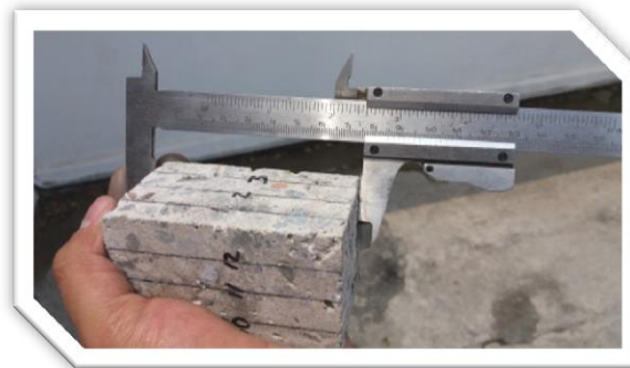
Fig. 6.19.- Medición de las líneas marcadas en el prisma con el vernier.
