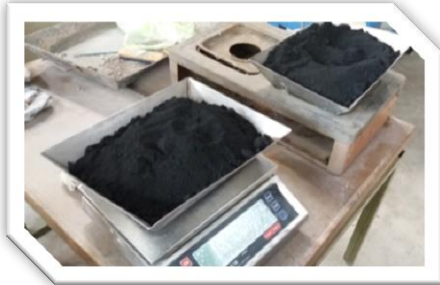
Fig. 5.25.- Dosificación del caucho en polvo.
