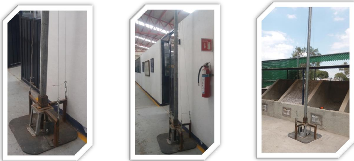
Fig. 6.33.- Dispositivo para evaluar la energía cinética traslacional sobre los adoquines, el cuerpo que impactara sobre los adoquines (o bala) cuenta con 5 cm de diámetro, una altura de 20 cm y una masa de 9 Kg.
