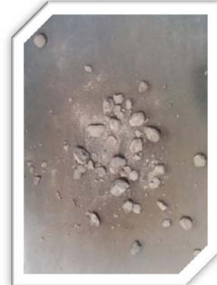
Fig. 3.20.- Al separar el material fino del más grueso se observa que aún existe humedad en el interior de las partículas apelmazadas.
