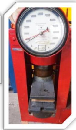
Fig. 6.11.- Compresión de adoquines adicionados con caucho.
