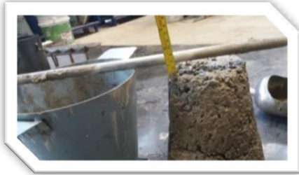
Fig. 5.11.- Verificación del revenimiento de la mezcla.
