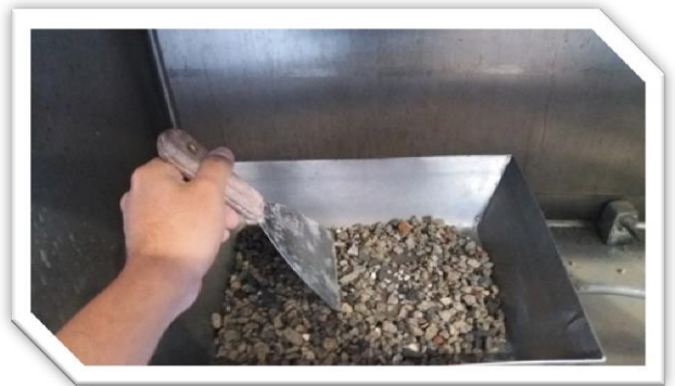
Fig. 3.15- Secado en fuego del agregado grueso en estado s.s.s. para determinar la absorción.
