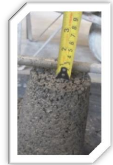
Fig. 5.33.- Revenimiento de la mezcla es de 1.5cm.
