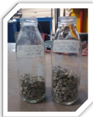
Fig. 3.12.- Del lado izquierdo preparación de las muestras y del lado derecho se observa el agregado grueso después de 48 horas de haberse sumergido en ácido muriático.
