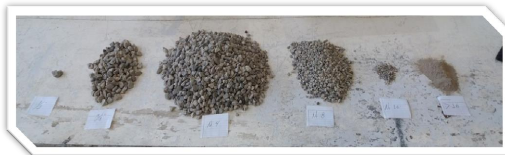
Fig. 3.7.- Distribución de las partículas del agregado grueso posterior al cribado ( Muestra 2 ), de izquierda a derecha se tienen los tamaños 1/2", 3/8", No.4, No.8, No.16 y lo que pasa No.16.
