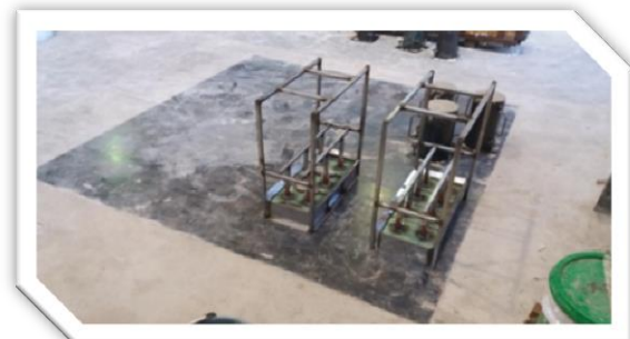
Fig. 5.9.- Adoquineras ya ensambladas.
