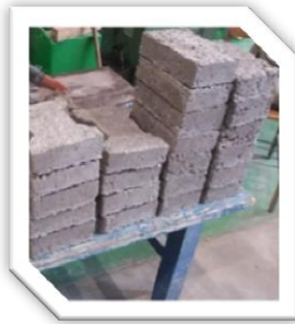
Fig. 5.44.- Preparación de las piezas para ser ingresadas a la cámara de curado.
