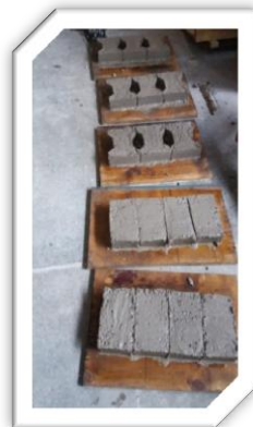
Fig. 5.21.- Apariencia de los adoquines después de haber sido desmoldados.
