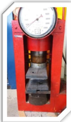
Fig. 6.7.- Aplicación de carga a los adoquines adicionados con caucho.
