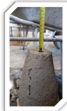
Fig. 5.15.- Verificación del revenimiento de la mezcla.
