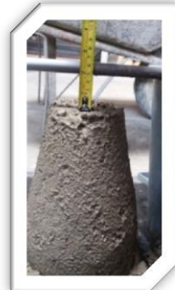
Fig. 5.42.- Revenimiento de la mezcla es de 4.5 cm.
