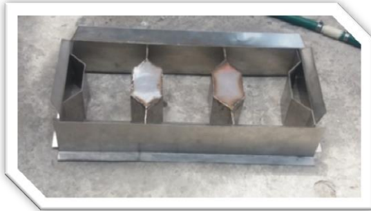
Fig. 5.4.- Presentación de las piezas que conforman el molde antes de aplicar soldadura de arco eléctrico.
