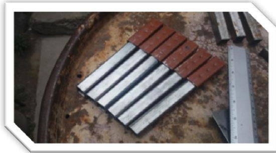
Fig. 5.6.- Medición y corte de las extensiones que servirán para ajustar el espesor entre 6cm y 8cm de los adoquines.
