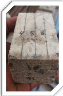
Fig. 6.22.- Desgaste que presentan las probetas después del ensaye.
