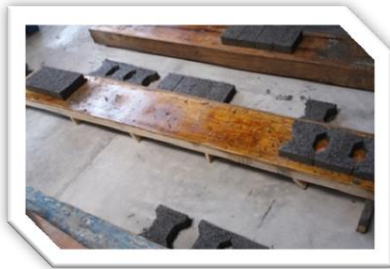
Fig. 5.34.- La apariencia de los adoquines terminados, es mucho mejor que las mezclas anteriores.
