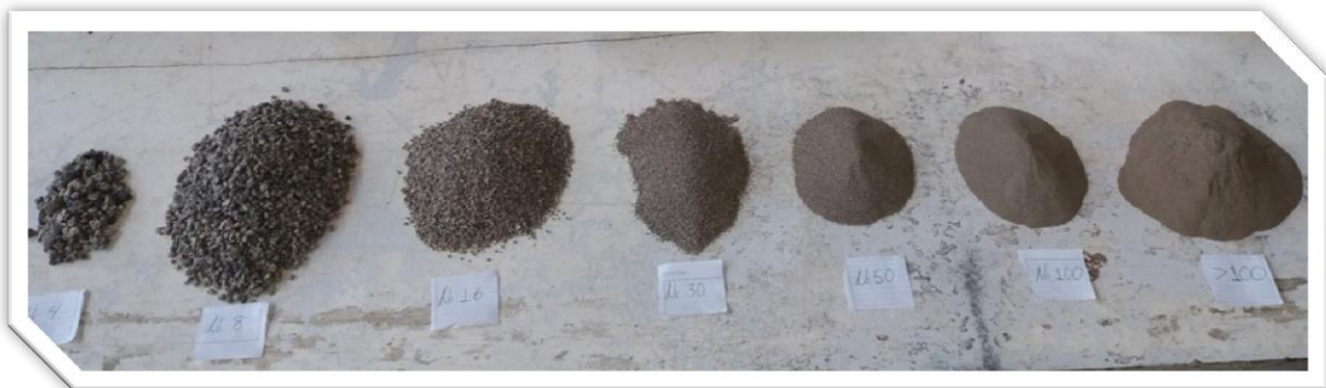
Fig. 3.8.- Distribución de las partículas del agregado fino posterior al cribado ( Muestra 1 ), de izquierda a derecha se tienen los tamaños No.4, No.8, No.16, No.30, No.50, No.100 y lo que pasa No.100.
