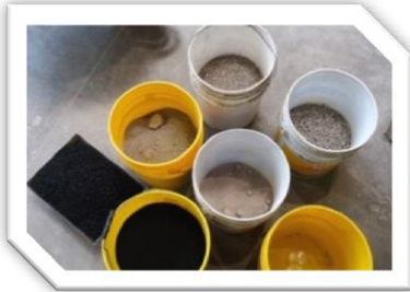
Fig. 5.36.- Vista de los materiales ya dosificados antes de ser mezclados.
