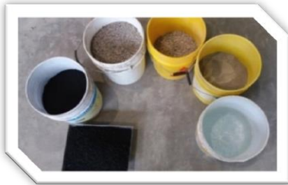
Fig. 5.31.- Vista de los materiales ya dosificados antes de ser mezclados.
