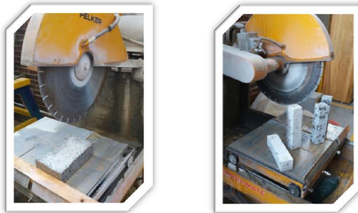
Fig. 6.28.- Labrado de muestras para el ensaye de resistencia a flexión.
