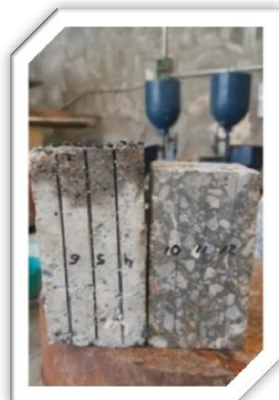
Fig. 6.25.- Las probetas con caucho presentan mayor resistencia a la abrasión en comparación de las probetas que no contienen caucho.
