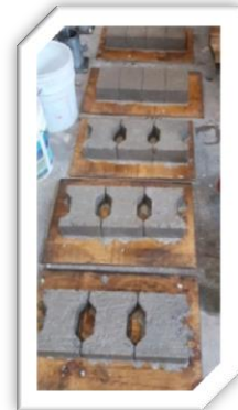
Fig. 5.16.- Apariencia de los adoquines después de ser desmoldados.
