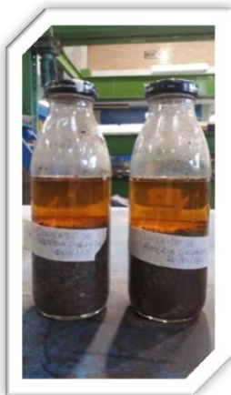
Fig. 3.10.- Del lado izquierdo se observa que la solución de hidróxido de sodio presenta un color oscuro después de haber sumergido agregado fino por 24 horas.
