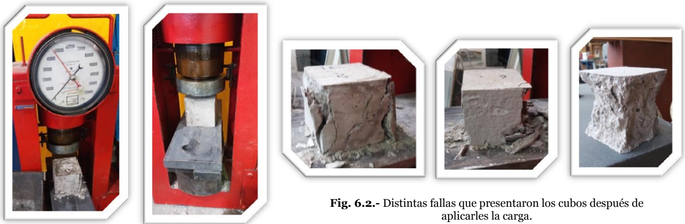
Fig. 6.1.- Resistencia a compresión en cubos de concreto.
