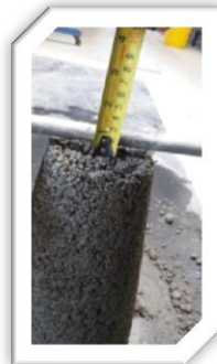
Fig. 5.37.- Revenimiento de la mezcla es de 1 cm.
