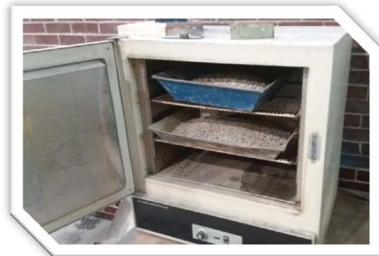
Fig. 3.5.- Secado en horno de los agregados reciclados.
