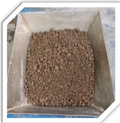
Fig. 3.18.- Arena reciclada en estado saturado superficialmente seco.
