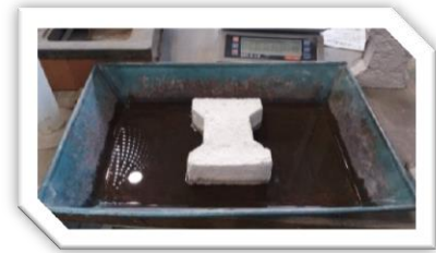
Fig. 6.32.- Los adoquines permanecieron en contacto con la película de agua por 10 min para verificar la absorción máxima de cada pieza.
