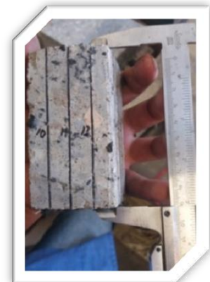
Fig. 6.26.- Posteriormente al ensaye de abrasión se miden las muestras para obtener la diferencia de longitudes por desgaste.
