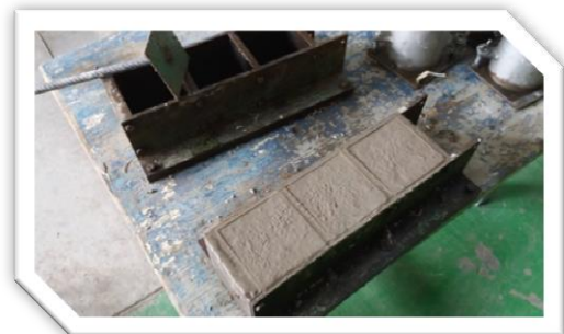
Fig. 5.22.- Elaboración de los especímenes cúbicos.
