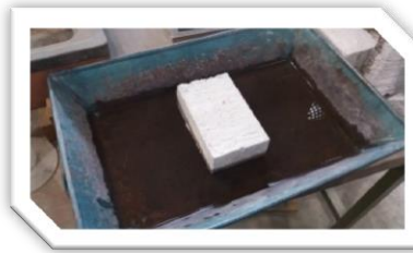
Fig. 6.32.- Los adoquines permanecieron en contacto con la película de agua por 10 min para verificar la absorción máxima de cada pieza.
