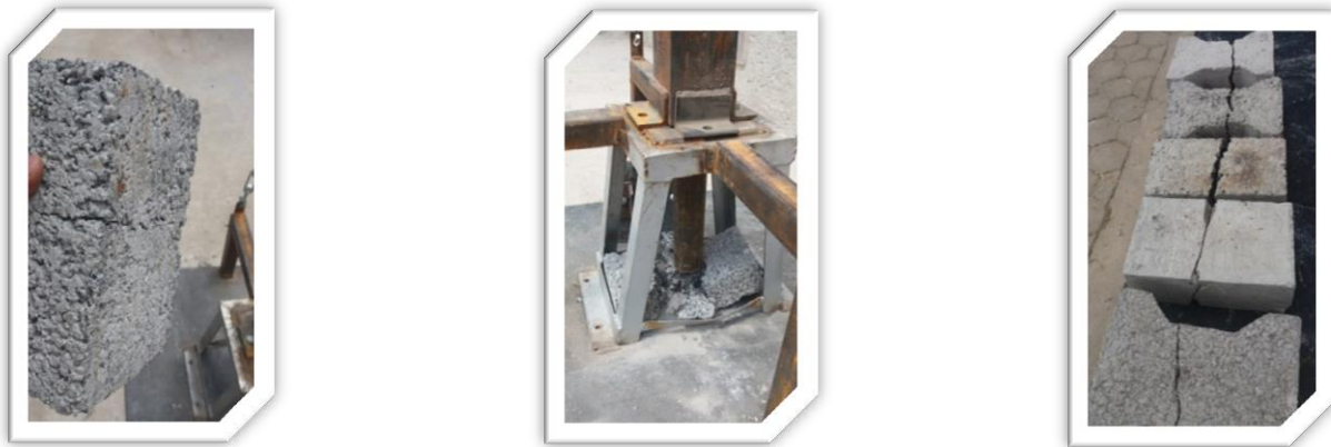
Fig. 6.35.- La cohesión de los agregados en los adoquines con caucho es mejor que en los adoquines sin caucho.
