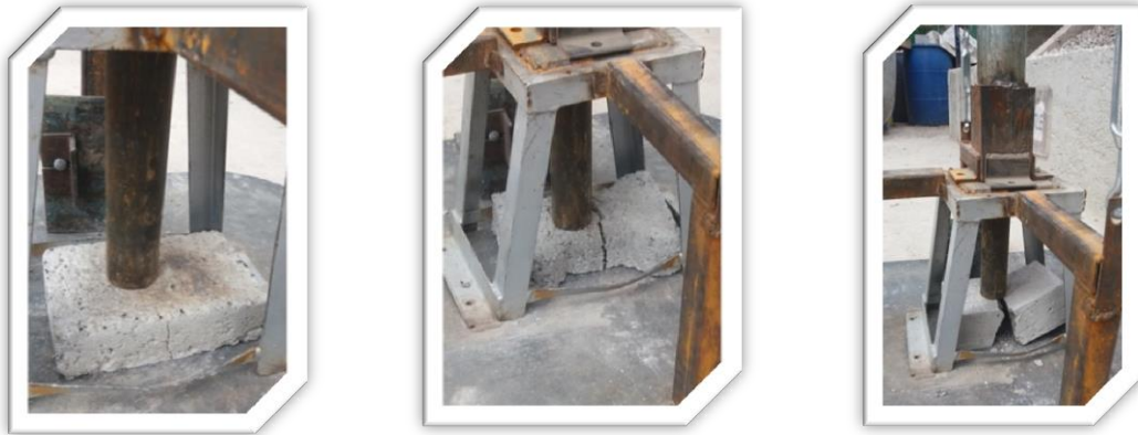
Fig. 6.34.- En las imágenes se muestran los distintos comportamientos que mostraron los adoquines frente al impacto de un cuerpo en caída libre, del lado izquierdo se muestran fisuras, en el centro se puede apreciar un agrietamiento y del lado derecho la falla total de un adoquín.
