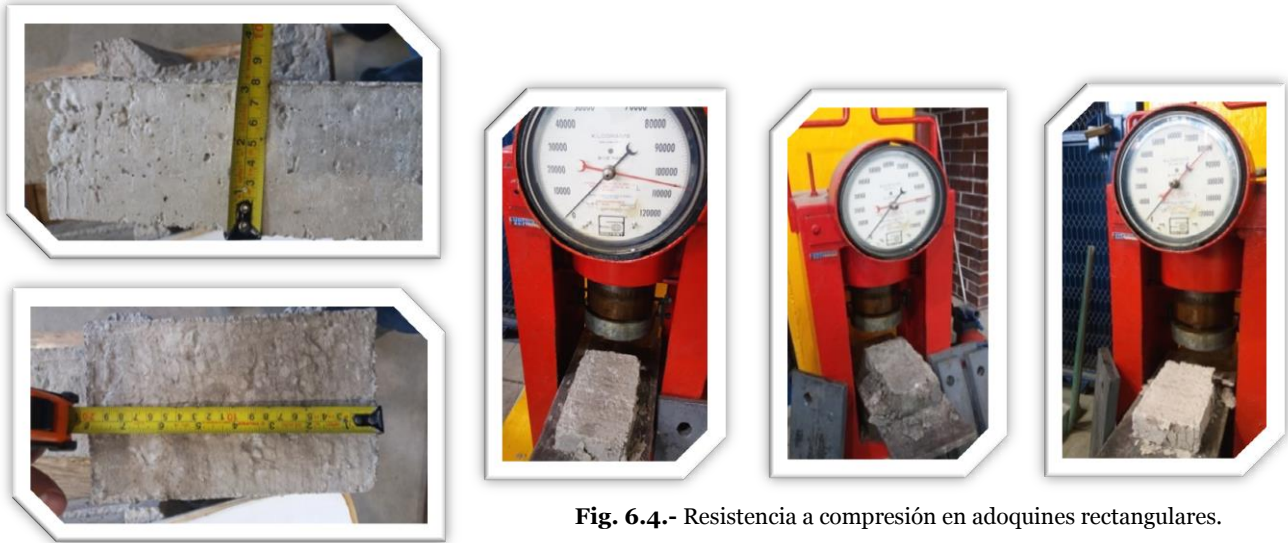
Fig. 6.3.- Obtención de las características geométricas de los adoquines rectangulares.
