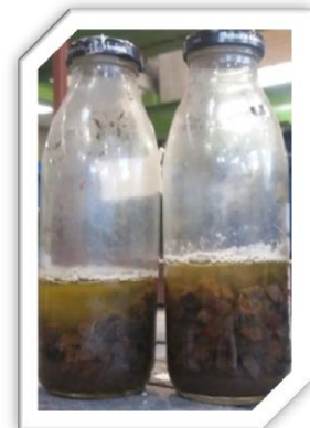
Fig. 3.12.- Del lado izquierdo preparación de las muestras y del lado derecho se observa el agregado grueso después de 48 horas de haberse sumergido en ácido muriático.
