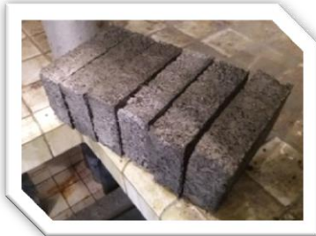
Fig. 5.39.- Los adoquines presentan una mejor uniformidad geométrica.
