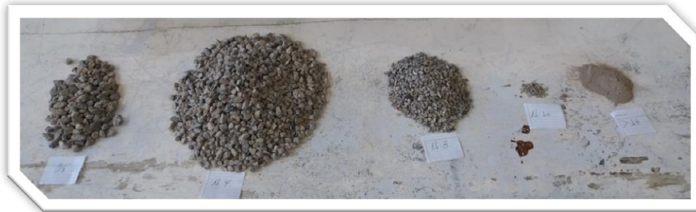
Fig. 3.6.- Distribución de las partículas del agregado grueso posterior al cribado ( Muestra 1 ), de izquierda a derecha se tienen los tamaños 3/8", No.4, No.8, No.16 y lo que pasa No.16.
