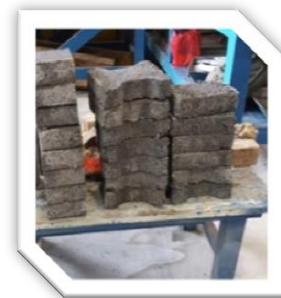
Fig. 5.40.- Preparación de las piezas para ser ingresadas a la cámara de curado.
