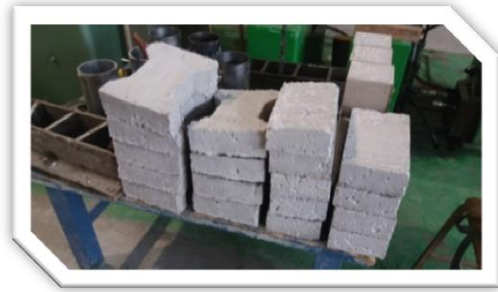
Fig. 5.19.- Preparado de los adoquines para poderlas introducir al cuarto de curado.
