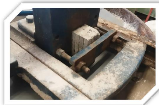
Fig. 6.21.- Especimen sujeto al porta probetas de la máquina durante el ensaye.
