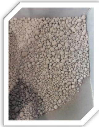
Fig. 3.19.- Arena reciclada seca en fuego, aparentemente se observa que el material se encuentra totalmente seco.
