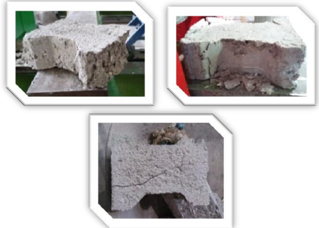
Fig. 6.6.- Algunas fallas que presentan los adoquines después del ensayo.
