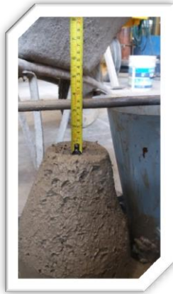
Fig. 5.17.- Verificación del revenimiento de la mezcla.
