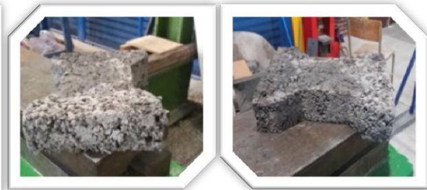
Fig. 6.12.- Fallas que presentan los adoquines después de haber sido sometidos a compresión.
