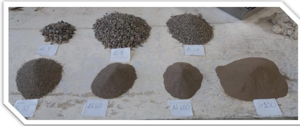
Fig. 3.9.- Distribución de las partículas del agregado fino posterior al cribado ( Muestra 2 ), de izquierda a derecha y de arriba hacia abajo se tienen los tamaños No.4, No.8, No.16, No.30, No.50, No.100 y lo que pasa No.100.
