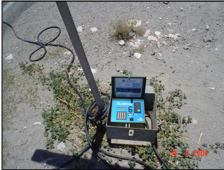
Figura 3.7.3. Equipo de aforo automático con clasificación vehicular
