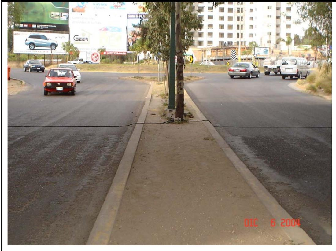
Figura 3.7.4. Sensores para conteo de ejes de vehículos
