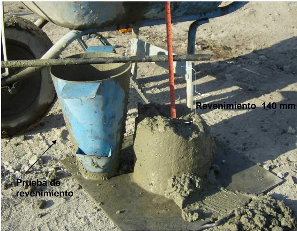
Foto 31 Prueba de revenimiento
