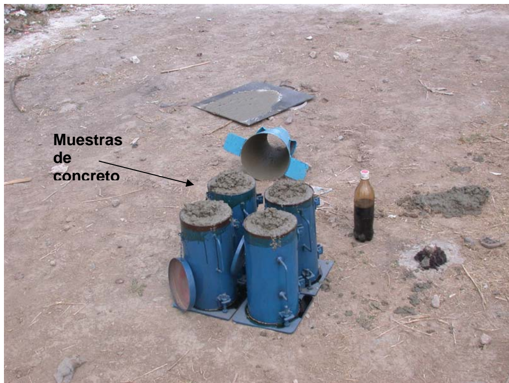
Foto 32 Muestras en cilindros para prueba de resistencia de concreto
