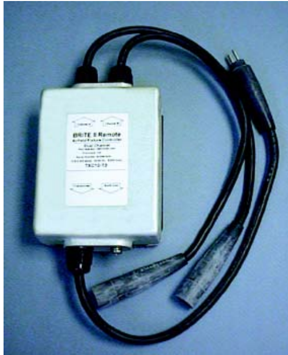
Fotografía V.34.- Brite para el monitoreo de las unidades luminosas con el sistema ALCS
