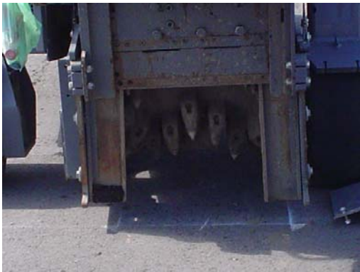
Corte con la perfiladora.
