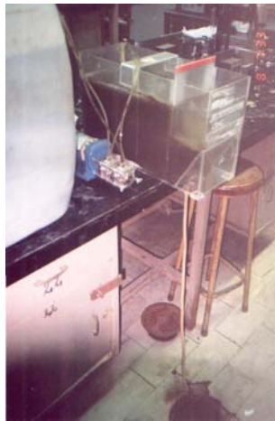
Foto IV.4 Funciones básicas, aireación y sedimentación.
