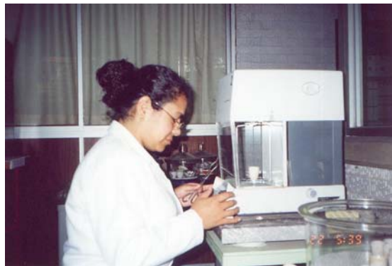
Foto IV.11 Peso de los crisoles Gooch con el filtro.
