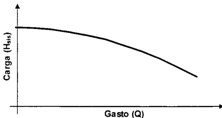
Fig. 7.6 Curva característica (carga-gasto) de una bomba
