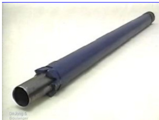
Figura 6.2. Muestreador Denison. Tomado de ocw.uis.edu.co/.../PERFORACION_Y_MUESTREO_DE_SUELOS
