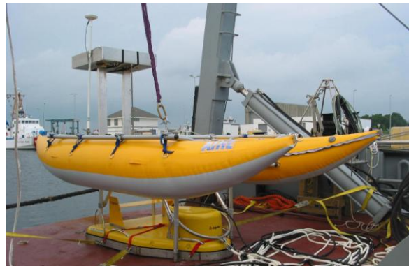
Figura I.18) Sistema chirp, montado en un trineo flotante. (Mosher y Simpkin 1999).
