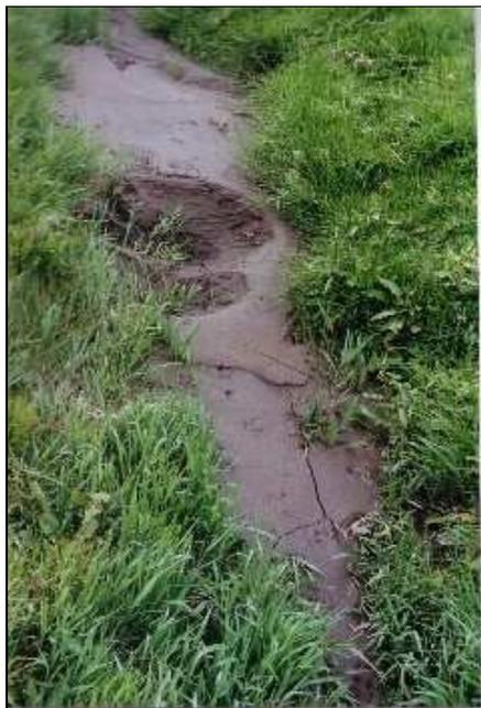
*Figura 2.19. Evidencia de licuación de arenas en un sembradío del Altiplano de Tlaxcala.
