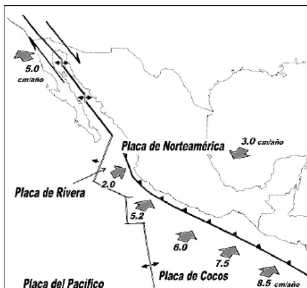
Figura 2.10. Límites y velocidades de desplazamiento (aproximados) entre placas. (Bitrán, et al., 2003)
