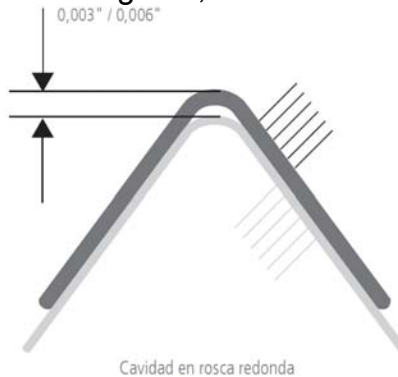
FIGURA 2-35. Acoplamiento de la Conexión 8HRR.
