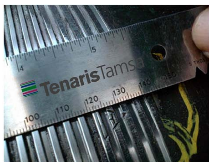
Posición del triángulo a 4 13/16" (122.1 mm) a partir de la base del piñón para diámetros de 20" y 13 3/8".
