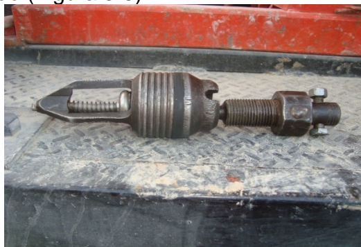
FIGURA 3-8. Válvula Tipo "H" con Pescante.
