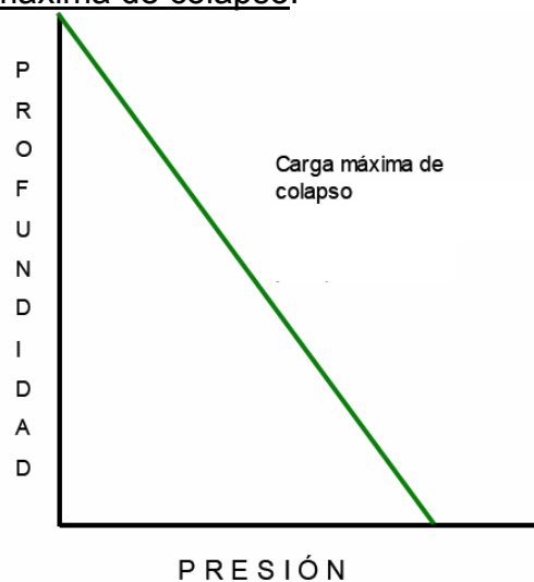
FIGURA 2-20. Línea de Carga Máxima de Colapso.
