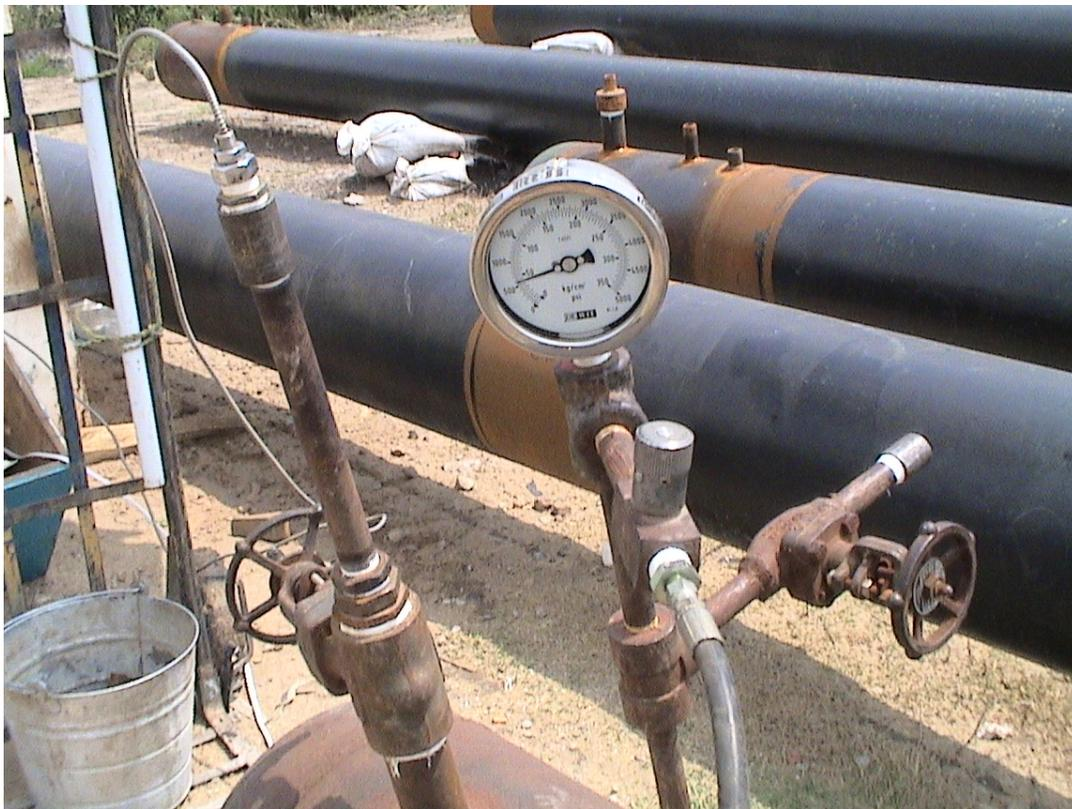
**MANÓMETRO PARA CONTROLAR LA PRESIÓN DEL TUBO EN LA PRUEBA**
