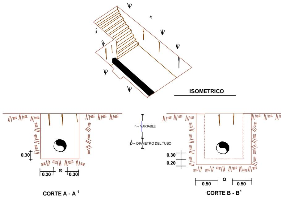
La longitud de la excavación dependerá de la magnitud de la falla a reparar y de la longitud mínima requerida para el método de reparación que se utilizará; que para el estudio de este trabajo es mediante la sustitución de tramos de tubería. Si al descubrir la tubería se observa que el recubrimiento mecánico se encuentra en mal estado, se deberá a criterio del supervisor, sobre-excavar hasta encontrar el punto donde el recubrimiento se encuentre en buen estado.
