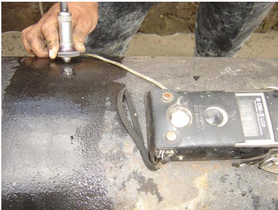
**EQUIPO DM-2 CON DISPLAY PARA LA CALIBRACIÓN**
