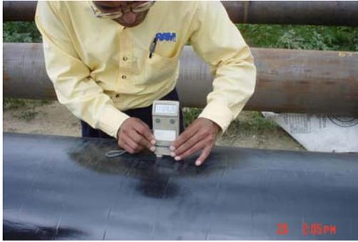
**PRUEBA DE ESPESOR DE
