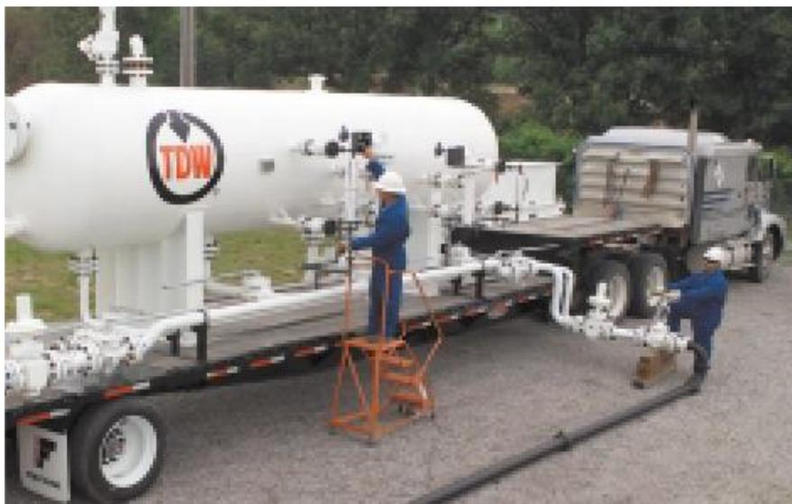
**EQUIPO DE INYECCIÓN DE NITRÓGENO**
