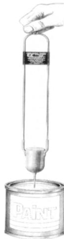
**COPA DE ZAHN PARA VERIFICAR LA VISCOSIDAD DEL RECUBRIMIENTO**
