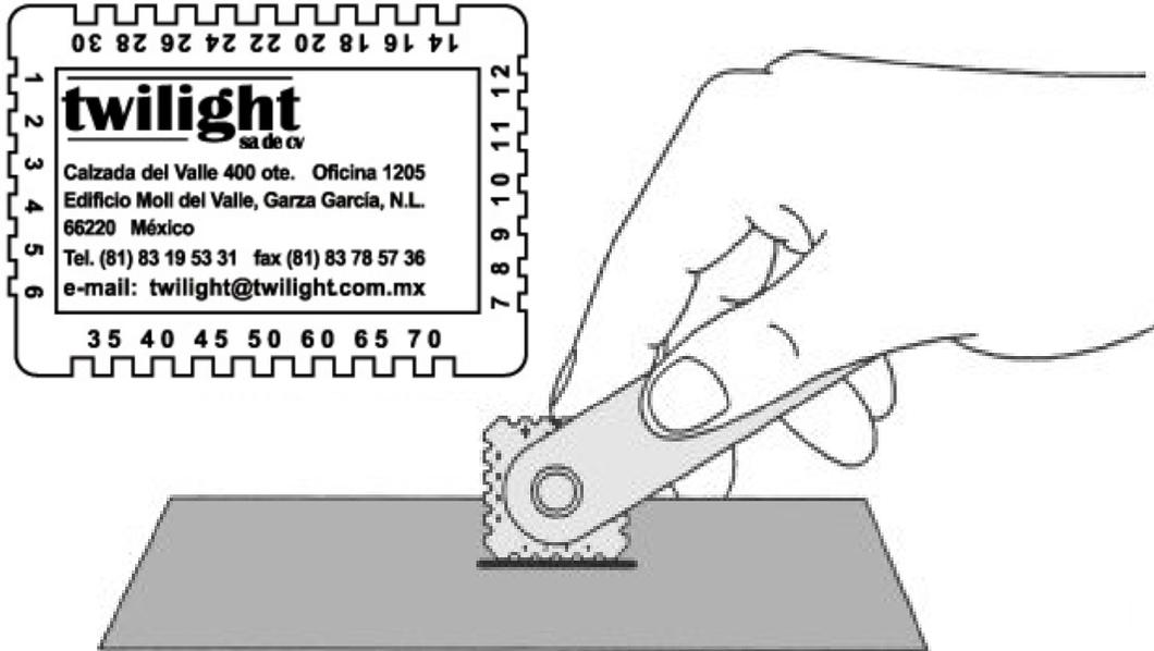
**EQUIPO NORSON PARA MEDIR EL ESPESOR DEL RECUBRIMIENTO HÚMEDO
