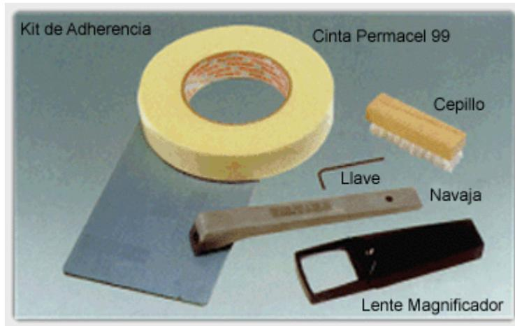
***KIT PARA MEDICIÓN DE LA ADHERENCIA DE RECUBRIMIENTO MECÁNICO
