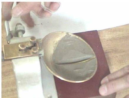
6. Se vuelve a mezclar el material y a ranurar para repetir la operación, si coincide el número de golpes, con tolerancia de un golpe, se anota el valor, y si no se repite hasta que coincida el dato en dos ocasiones sucesivas.
