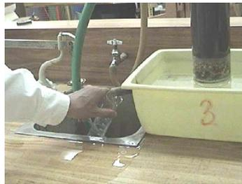
2. Una vez que el gasto es constante y sin movimiento de la carga, es decir que no se observen cambios en la parte superior, se toman las medidas de la altura del suelo contenido en el permeámetro a probar para planos perpendiculares al eje de rotación del cilindro, el diámetro interior del mismo y la distancia de espejo a espejo de agua que es la carga que debe mantenerse constante.
