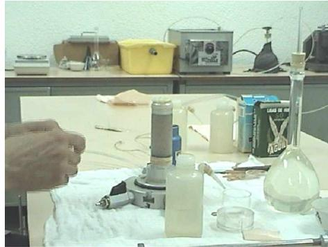
9. Se corta la liga del molde, se baja la bureta conectada al drenaje para generar vacío y se desconecta la línea de vacío conectada al molde. Se quita la liga para retirar el molde de dos mitades dejando la membrana a la vista, la probeta se sostiene con la presión negativa del agua.
