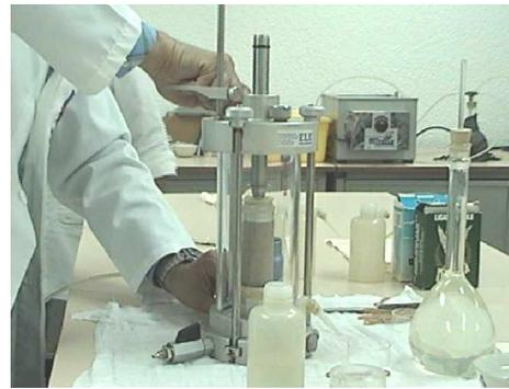
11. Se sube el agua para aplicar finalmente presión con un valor aproximado de 50 kPa.
