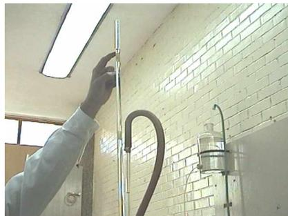
4. Finalmente se mide el diámetro interior del tubo que contiene al suelo y del tubo de alimentación.
