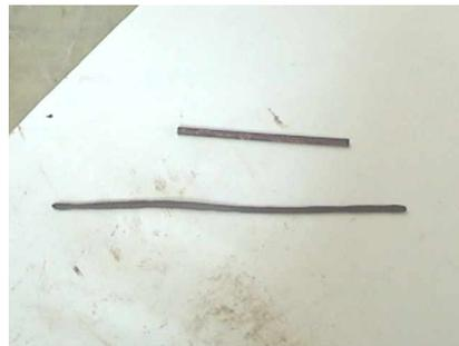
3. La operación se repite hasta que el rollo se sienta un poco duro, lo que indicará que ha perdido su humedad por evaporación.
