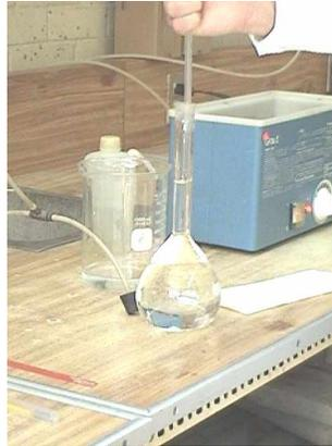
7. Se elimina otra vez el agua del cuello del matraz con papel, se seca el matraz por fuera. Ya aforado y seco, se mide la masa del matraz al 0,01g anotando la masa.
