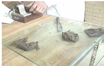
4. Se hace una ranura en el centro de la muestra colocando el ranurador perpendicularmente a la tangente de la superficie de la copa en toda la muestra.
