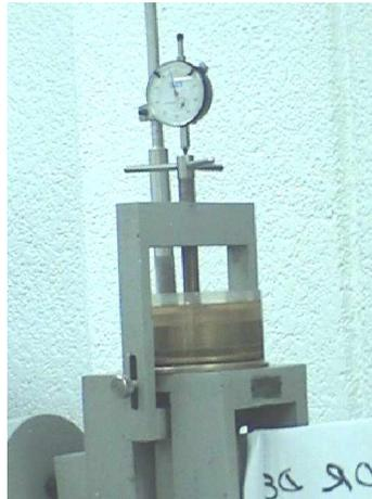
6. Listo el dispositivo se anota el valor del extensómetro antes de dar el primer incremento de carga, en el tiempo cero, y después se toman las lecturas en diferentes tiempos de 5, 15, 30, 60, 120, 240 segundos y así sucesivamente hasta que se completen las 24 horas.
