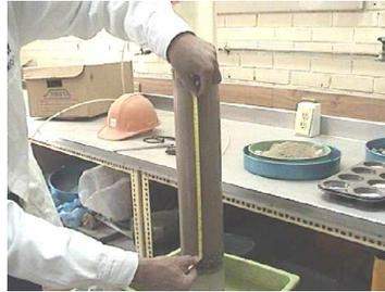
3. Para medir el tiempo, un alumno debe colocarse al nivel de las marcas, cuando se da libre salida al agua, e iniciar el tiempo exactamente al llegar la parte inferior del menisco a la marca superior del tubo, y detener el cronómetro al llegar a la marca inferior.
