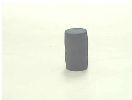
3. Se mide la masa de la cápsula de vidrio pirex, después se mide la masa de la cápsula más la masa de la probeta, se mete al horno. Una vez seca se vuelve a medir la masa, para obtener el contenido de agua antes de la prueba y después de la prueba.
