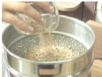
3. Para realizar el cribado es preferible utilizar un agitador mecánico, para que el movimiento sea vertical y horizontal, de manera uniforme por lo menos durante 5 minutos.
