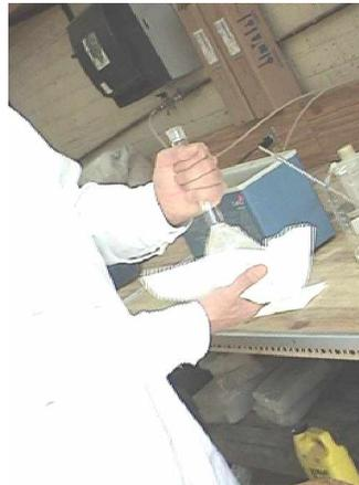
6. Se coloca el matraz sobre papel para secar y se deja enfriar; dado que el nivel del agua disminuye con la disminución de la temperatura, con la pipeta se agrega un poco de agua destilada hasta 1 mm por encima de la marca.
