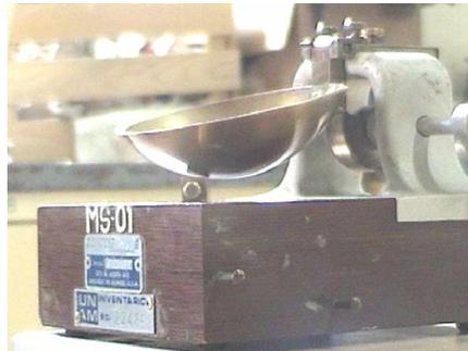
2. Se toman de 40 a 50 g de la muestra de suelo saturado, y remoldeado, puesto en bolsas cerradas, para que no pierda su la humedad, 24 h antes de la realización de la prueba.
