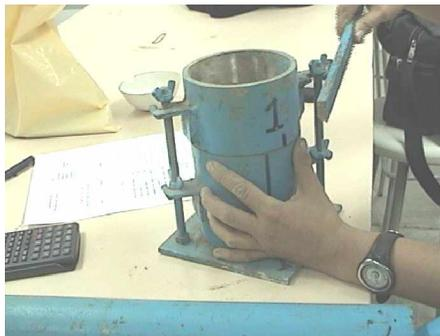
8. Al levantar el copete el suelo compactado puede quedar 1 cm por encima del borde superior del molde si no es así se repite la prueba. Pero si está en rango, se recorta el material excedente con una regleta afilada dejando caer el material sobrante y se limpia.
