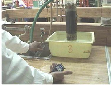
4. Se mide la masa de la probeta más el líquido desfogado, se obtiene la diferencia de masas, y se obtiene el volumen tomando en cuenta que se supone una densidad para el agua de  $\rho_{w0}=1 \text{ g/cm}^3$ .
