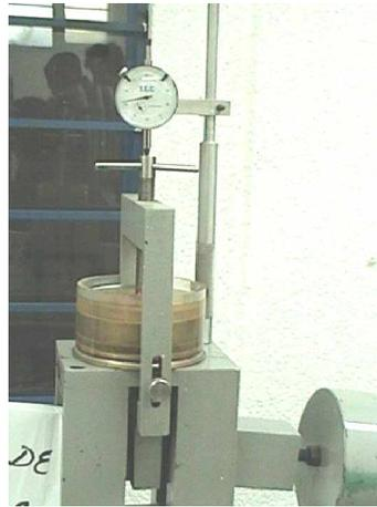
5. Se coloca el extensómetro y se coloca un pesa pequeña para garantizar el contacto.
