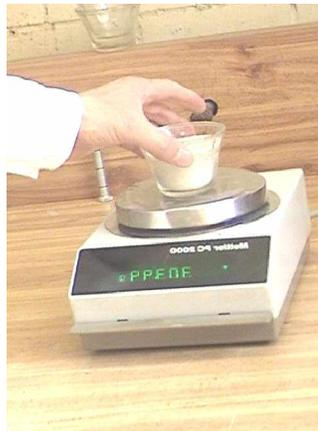
2. En el matraz de 500 cm<sup>3</sup> se colocan 100 cm<sup>3</sup> de agua destilada aproximadamente, y se toma la masa del conjunto, la cual debe leer con una aproximación de 0,01 g.
