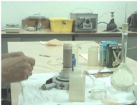
10. Cuando la probeta esta formada se coloca la camisa de la cámara triaxial, se sube el vástago del marco de carga para no golpear la probeta, una vez en su lugar se gira para centrarlo bien.
