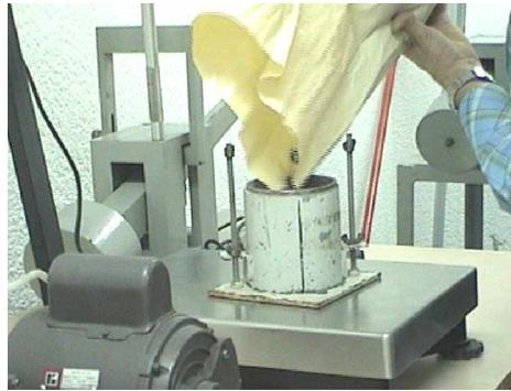
3. Cuando se alcanza dicha masa se baja el molde al suelo y entre dos personas se le aplican 25 golpes. Una persona con las dos manos coloca el tubo guía y otra sube el martillo a tope para dejarlo caer. La primera persona alinea el tubo con el nivel superior del suelo.
