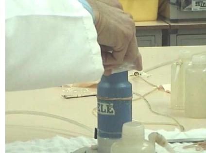
7. Se prepara una cantidad definida de masa de arena en agua desaireada dentro de un matraz. Esta agua permite una lluvia de arena en agua para lograr un estado suelto y depositarla en el molde interior de la cámara triaxial.
