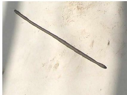
4. Cuando esto sucede y llegando a los 3,2 mm, se tienen el límite plástico cuando el rollo se agriete o desmorone en este diámetro. Entonces se dobla y se coloca en un vidrio de reloj, para medir su masa y obtener su contenido de agua y se registran los datos en el formato 2.a.1
