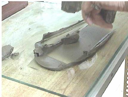
3. Se coloca en la copa, mezclándose de nuevo hasta que sea homogénea, se coloca formando una superficie plana de un centímetro de altura como máximo.
