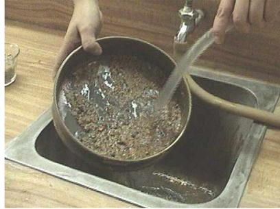
Al material que pasa por la 200, se le puede aplicar otro análisis, vía húmeda. Como ya se mencionó antes, este procedimiento no se hará en esta práctica. El material retenido se coloca en una cápsula de vidrio para regresar al horno 24 h como ya se había hecho. Para la parte que maneja el alumno, se saca del horno y se deja enfriar de la misma forma y se vuelve a medir la masa del suelo lavado y seco más la masa del recipiente.
