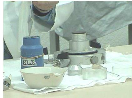
3. Después se coloca una membrana elástica de látex para contar con una frontera impermeable.
