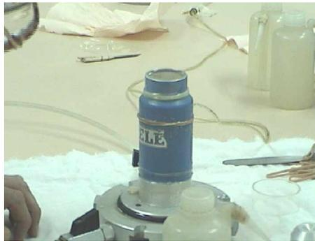
8. Una vez vaciada la arena se quita la extensión, se dobla la membrana, se coloca la cabeza ciega y tapada, y se sube la membrana. Se coloca otra liga de cierre la cabeza ciega.
