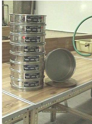
2. Para cribar se ordena el juego de mallas de la 4 a la 200 se realiza el cribado de la muestra colocando la malla cuatro en la parte superior y continuando de con las de menor diámetro de abertura, agregando la charola y la tapa como se ilustra.
