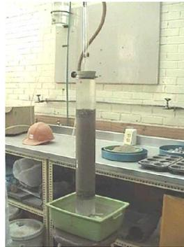
2. Se miden las dos marcas sobre el tubo de alimentación una en la mayor altura o carga posible y la otra en un punto cercano al comienzo del tubo del permeámetro desde el espejo de agua en el recipiente que contiene al permeámetro. Posteriormente se eleva el agua hasta llegar un poco por encima de la marca superior, manteniendo cerrado el tubo de la salida del agua.
