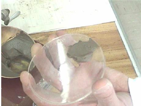
9. Se repite el procedimiento con muestras de por lo menos cuatro diferentes contenidos de agua. Dos deben quedar entre 5 y 25 golpes y otros dos entre 25 y 50 golpes. Se registran en el formato 2.a.1
