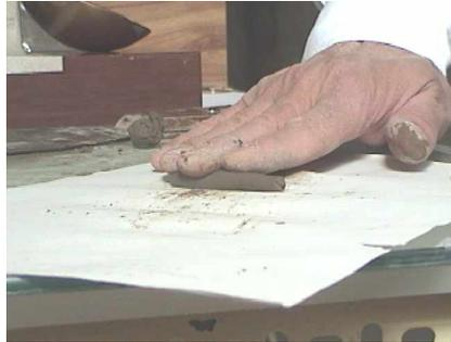
2. Si el material está muy saturado se puede trabajar sobre una hoja de papel bond para que suelte humedad, en caso de romperse el rollo se reintegra el material y se reinicia el proceso hasta lograr un diámetro de 1/8 de pulgada (3.2 mm), se puede comparar con una varilla de dicha medida, y el desmoronamiento o agrietamiento debe suceder cuando se tenga esta medida.
