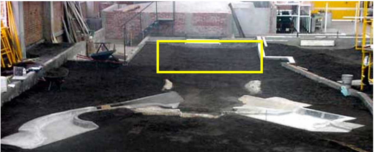
Fig. 4.3 Extensión de la batimetría aguas abajo de las estructuras
