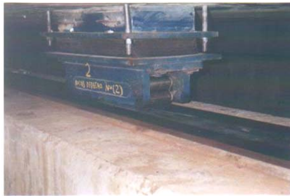
Dispositivo móvil denominado "roller", utilizado en el parque de fabricación.
