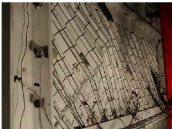
a) Panel con placa corrugada laminada en frío, a un desplazamiento de 3 veces el de la primera fluencia
