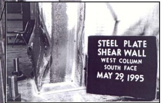
Fig. I.2-7. Pandeo local de una columna, al final de la prueba. (Driver et al; 1996)
