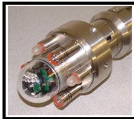
Figura 3.33 Cámara utilizada para el Borehole Video.
