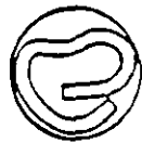
1e) Doblado o rizado de extremo de tubo
