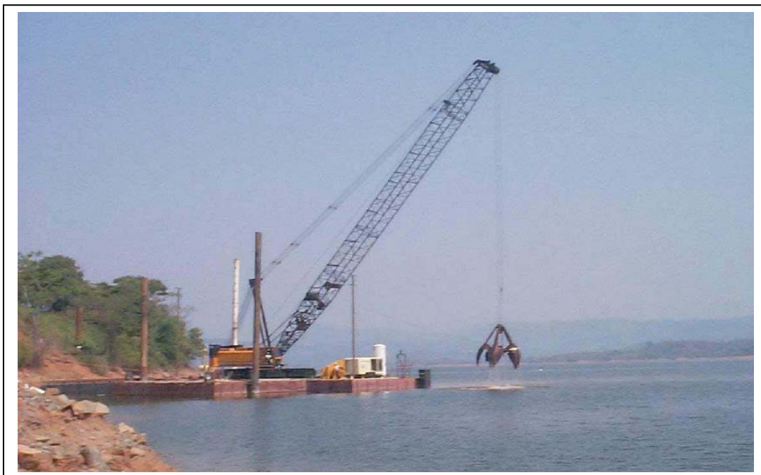
Figura 2.8 Draga para la limpieza de fondo
