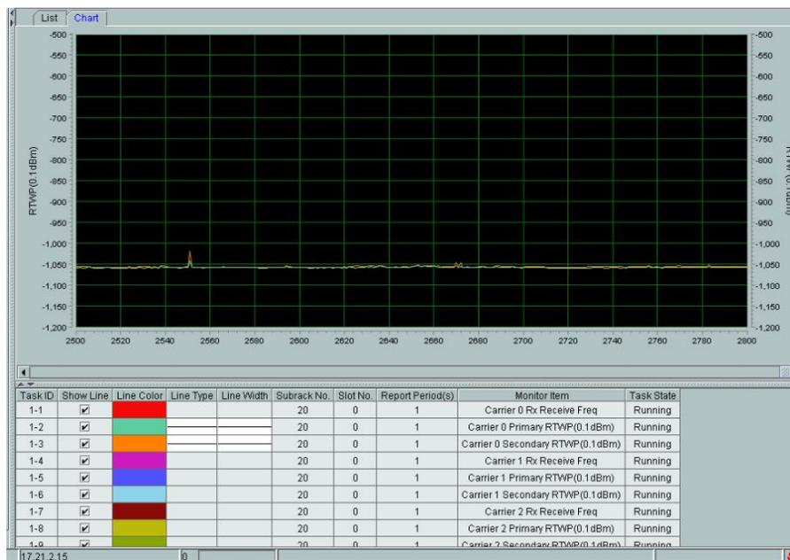
Figura 5-14. RTWP de una celda sin carga
