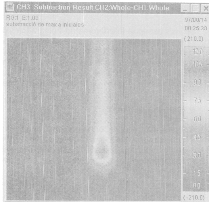
Figura 20. Termografía de rayos infrarrojos de una barra de refuerzo a tensión.
