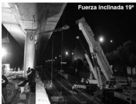
Fig. 4.1.11. Pruebas de tracción lateral con una grúa de 500 t (IINGEN 2005)
