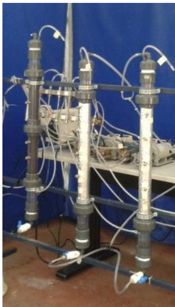
Figura 4.4. Sistema de biofiltración.
