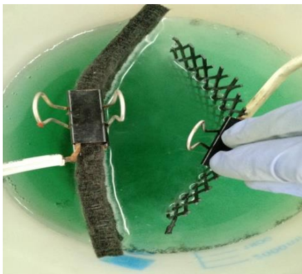
Figura 4.2. Electrodeposición del cátodo con níquel metálico
