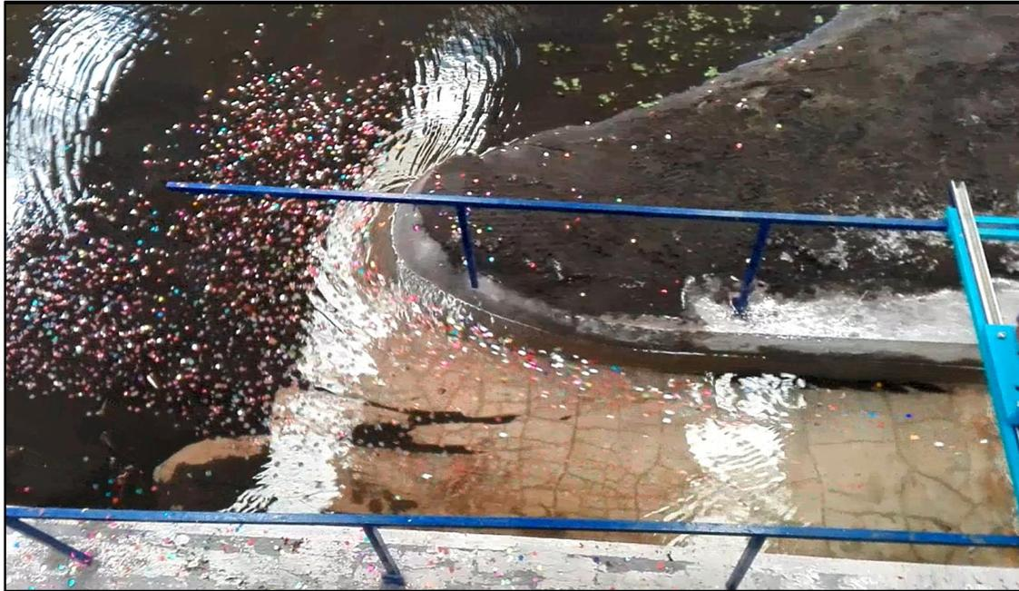
*Figura 6.1. Líneas de corriente sin depósito de sedimento*
