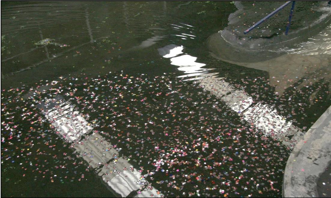
*Figura 6.3. Líneas de corriente con depósito de sedimento #1*
