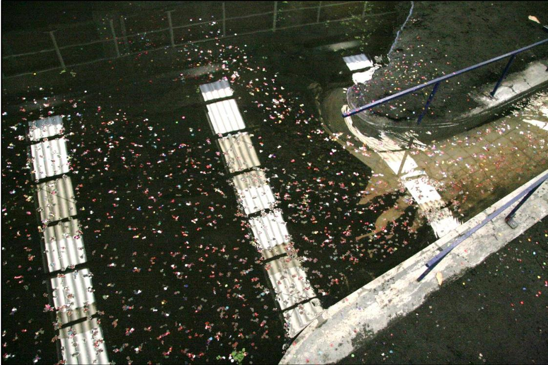
*Figura 6.6. Líneas de corriente con depósito de sedimento #3*
