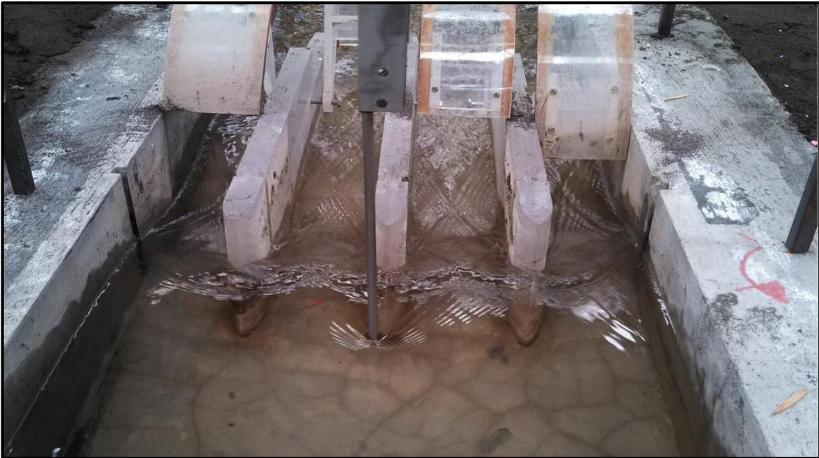
*Figura 3.3. Pilas y compuertas radiales del Modelo Físico*
