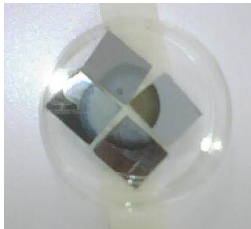
Imagen 3.9: Sustrato de silicio poroso dividido en 4
