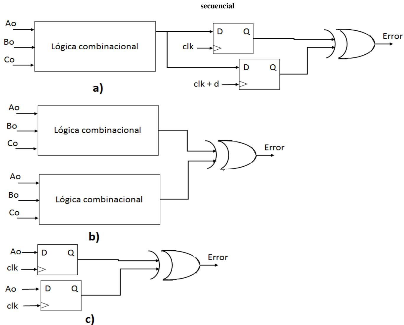
**Figura 36 a) Redundancia por tiempo b) Redundancia por hardware para lógica combinacional c) Redundancia por hardware para lógica**
