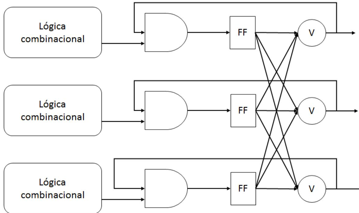
Figura 39 Votador para sincronización Adaptado de [20]
