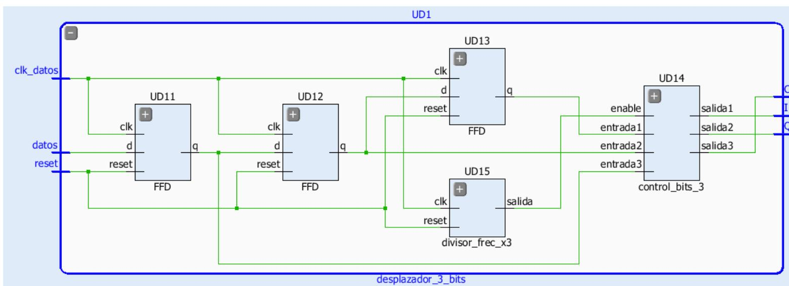
**Figura 40 Componentes que conforman el bloque desplazador\_3\_bits**
