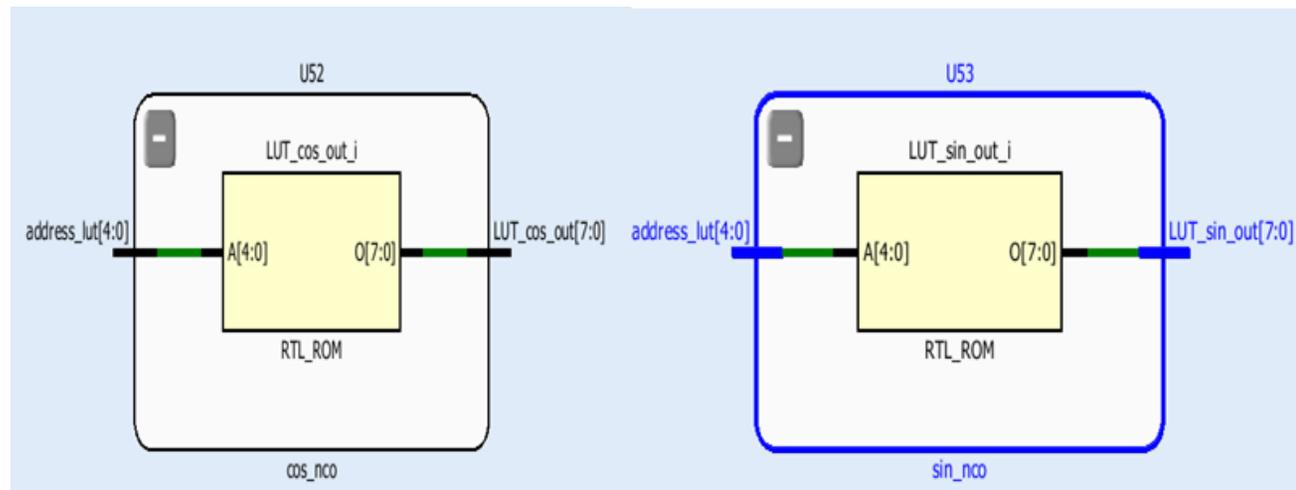
**Figura 52 Composición de las tablas de búsqueda**
