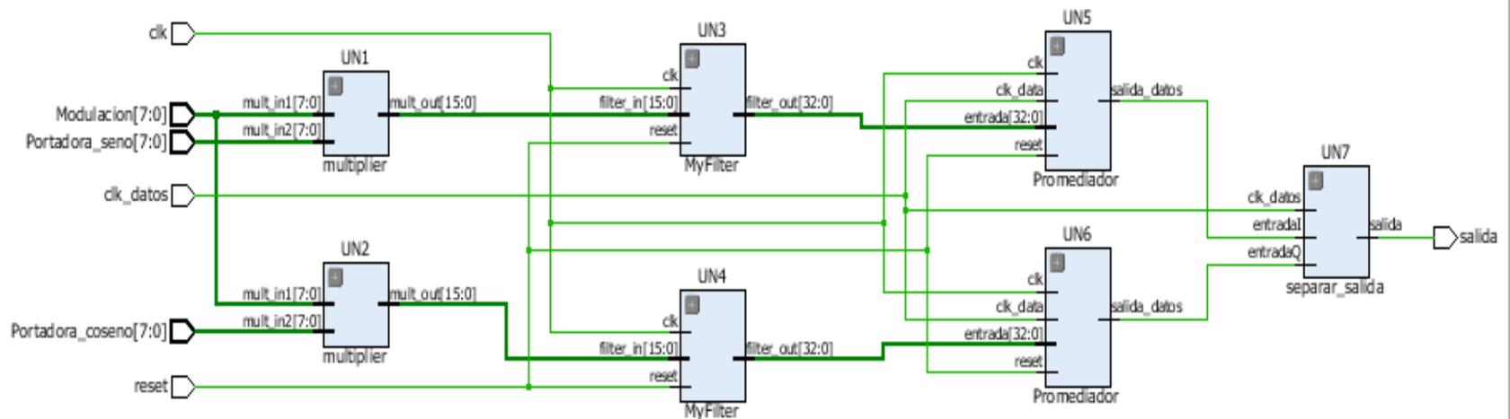
**Figura 50 Circuito digital implementado en Vivado del demodulador QPSK**
