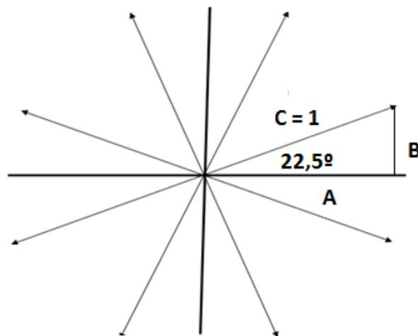
**Figura 8 Determinación de los coeficientes de amplitud para un modulador 8 PSK**
