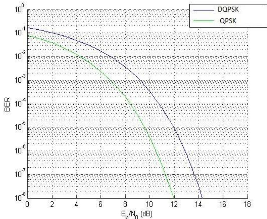
**Figura 1 Comparación del BER entre DPSK y QPSK**
