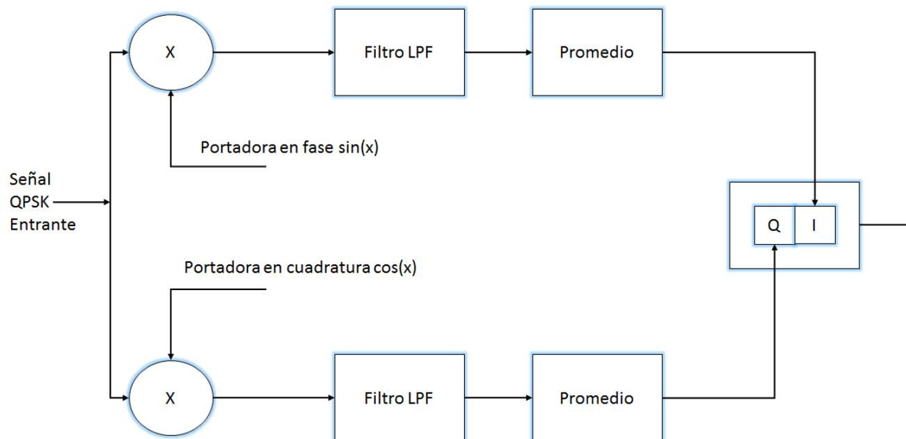
Figura 49 Esquema a bloques del demodulador QPSK
