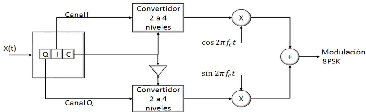
**Figura 7 Esquema del modulador 8PSK**
