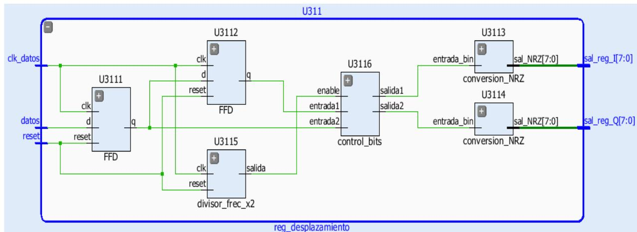
**Fig 34 Segundo nivel de abstracción del componente QPSKmodulator**
