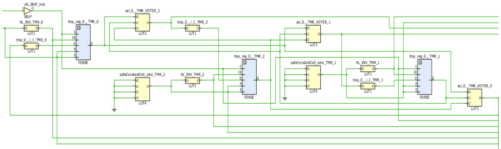
**Figura 44 Resultado de la síntesis del diseño replicado**
