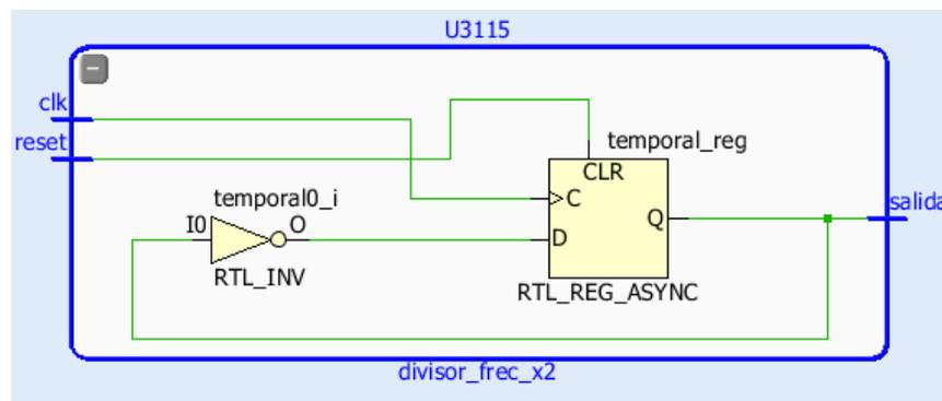
Figura 36 Interpretación del componente divisor\_frec\_x2 por Vivado
