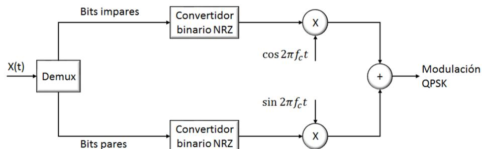
**Figura 5 Esquema del modulador QPSK**
