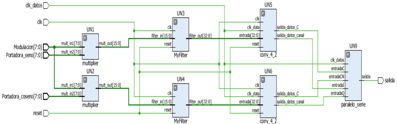
Figura 58 Circuito digital implementado en Vivado del demodulador 16QAM
