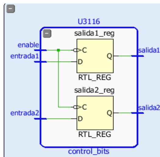
Figura 37 Interpretación del componente control\_bits por Vivado
