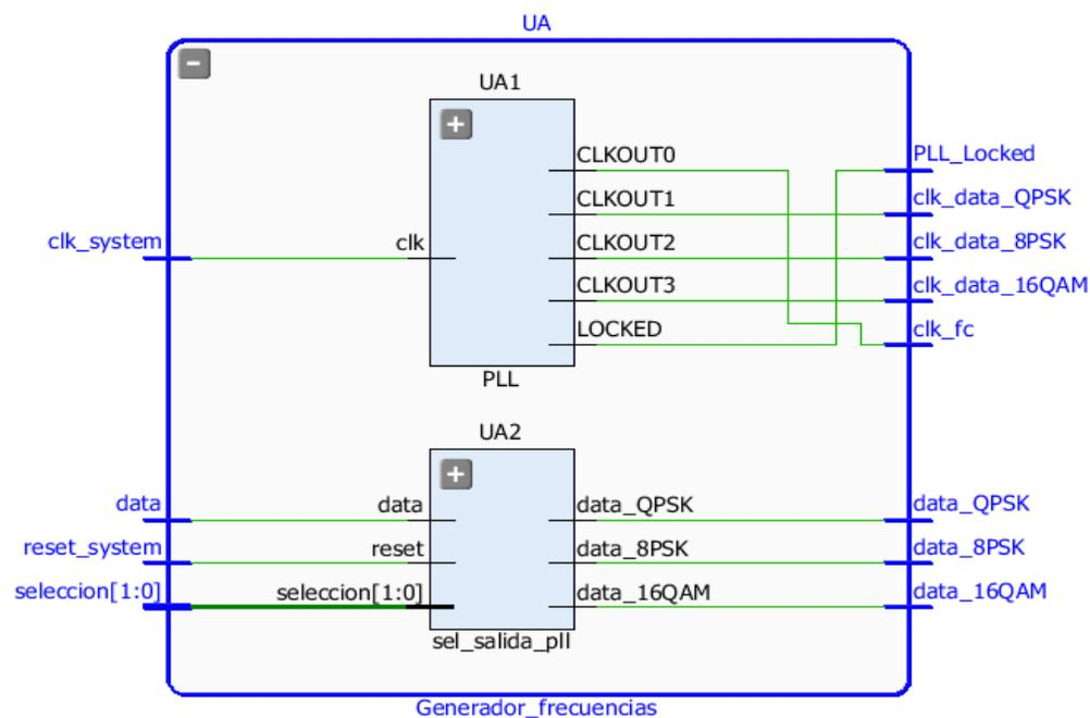
Figura 30 Top Level del bloque generador de frecuencias
