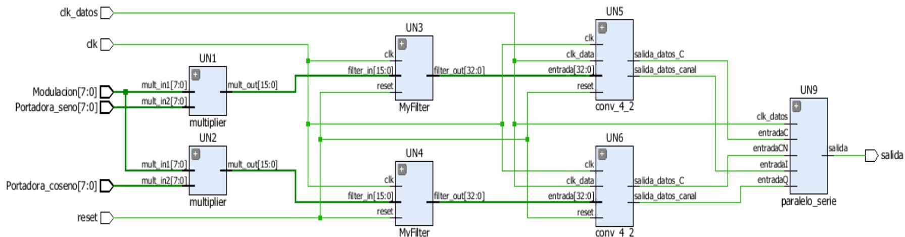
**Figura 54** Circuito digital implementado en Vivado del demodulador 8PSK
