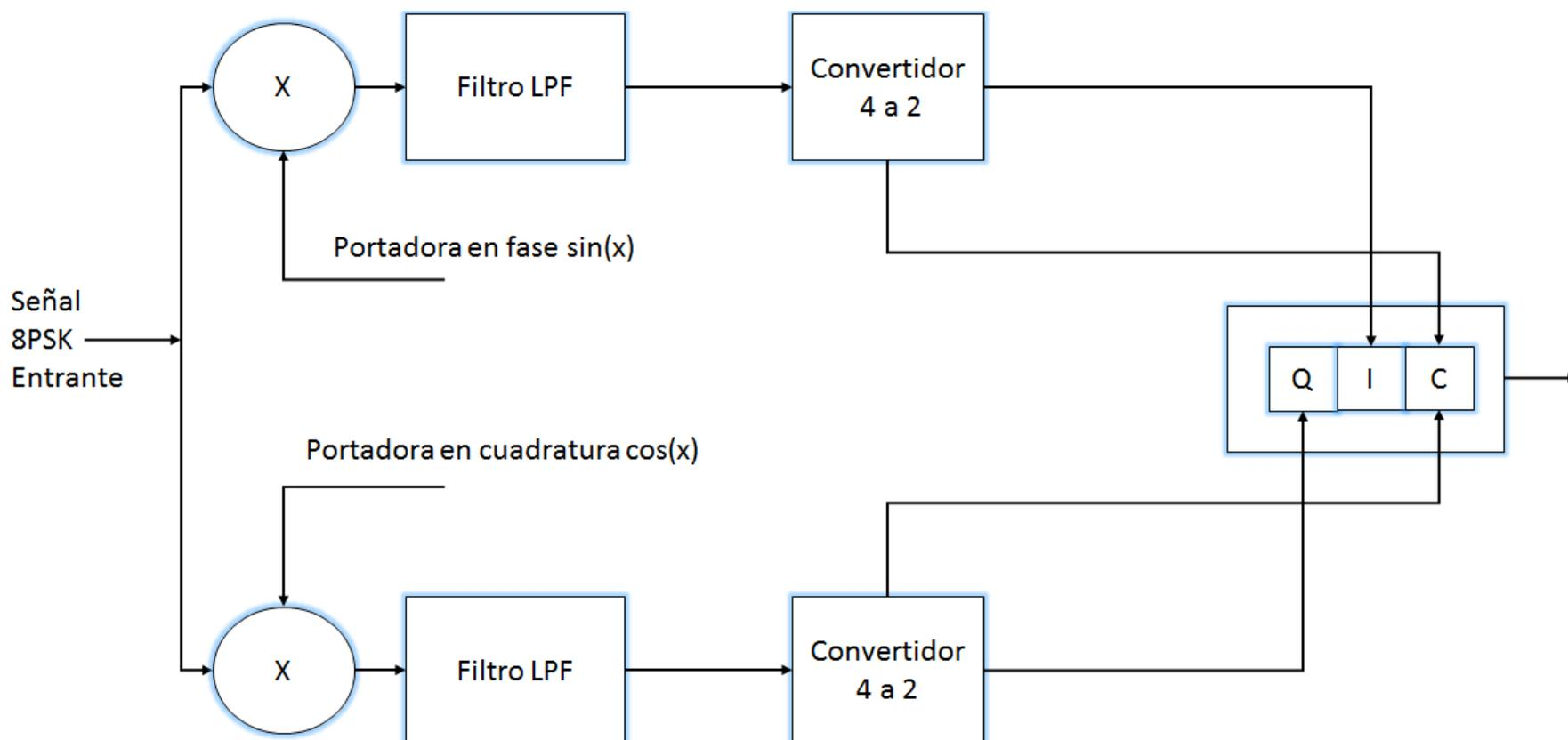
Figura 53 Esquema a bloques del demodulador 8PSK
