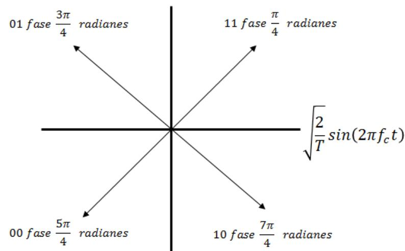
Figura 6 Constelación de la modulación QPSK
