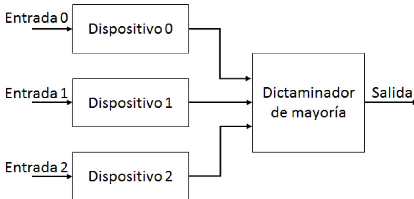
Figura 38 TMR en hardware *Adaptado de [4]*
