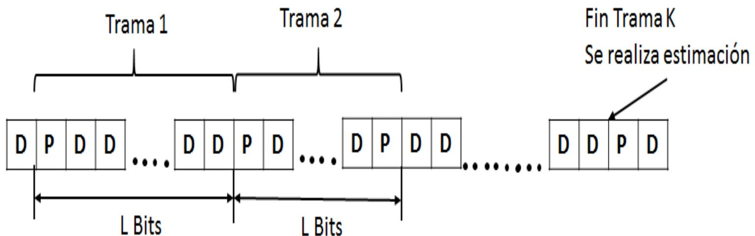
**Figura 26 Determinación del tiempo entre estimaciones Adaptado de [17]**
