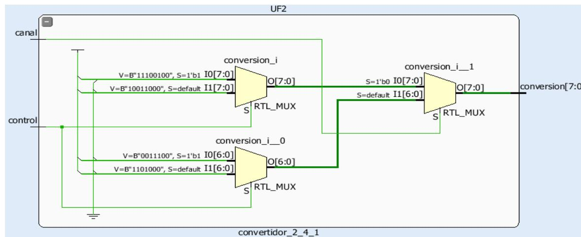
**Figura 48 Estructura interna del bloque convertidor\_2\_4\_1**
