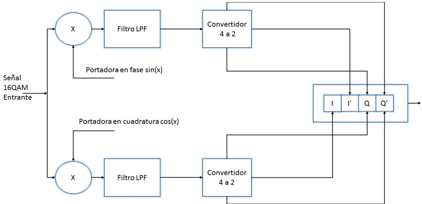
Figura 57 Esquema a bloques del demodulador 16QAM
