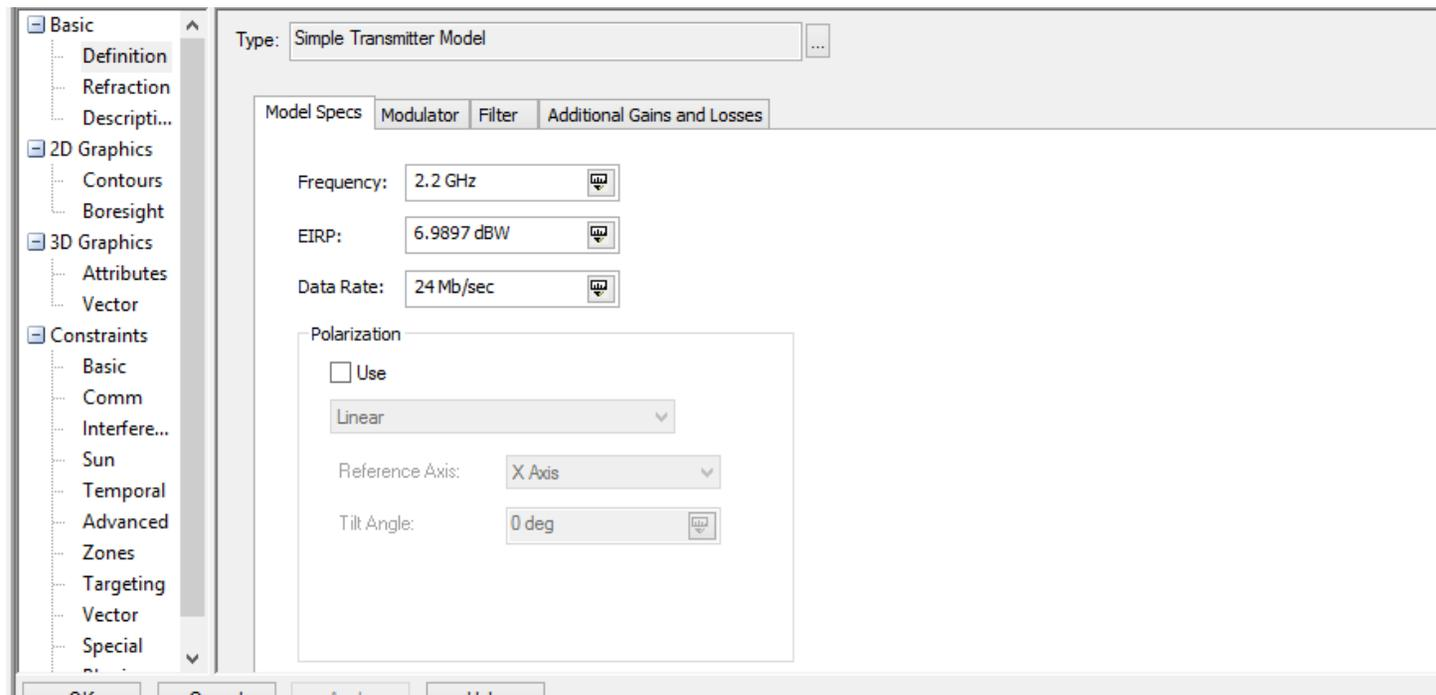
**Figura 16 Configuración de la antena del satélite**
