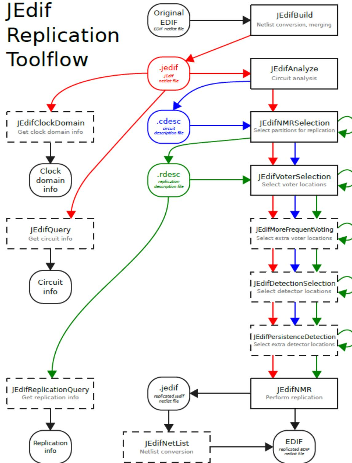
Figura 41 Flujograma de la herramienta JEdifTool Adaptado de [45]
