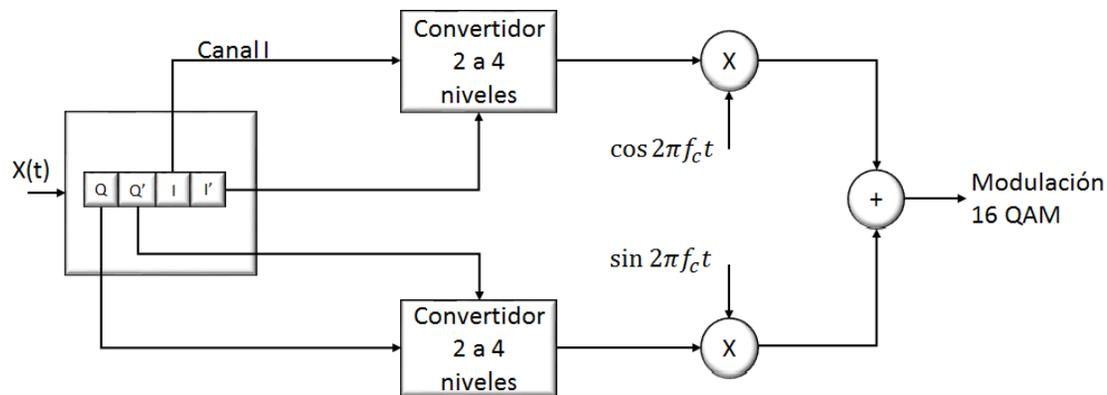
Figura 11 Modulador 16-QAM
