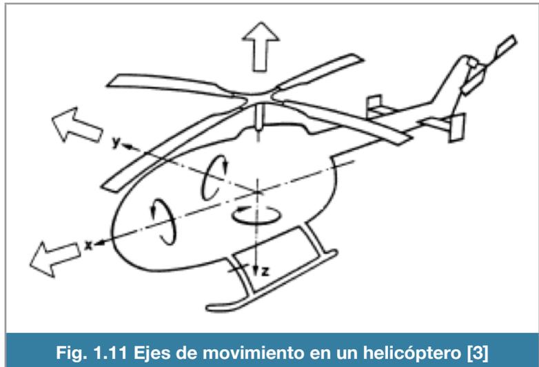
Fig. 1.11 Ejes de movimiento en un helicóptero [3]
