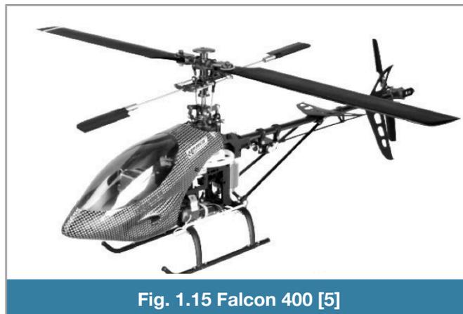
Tiene un motor eléctrico sin escobillas (*brushless*), y la capacidad de hacer vuelo acrobático así como vuelo 3D, que es exactamente lo que los helicópteros reales pueden hacer.
