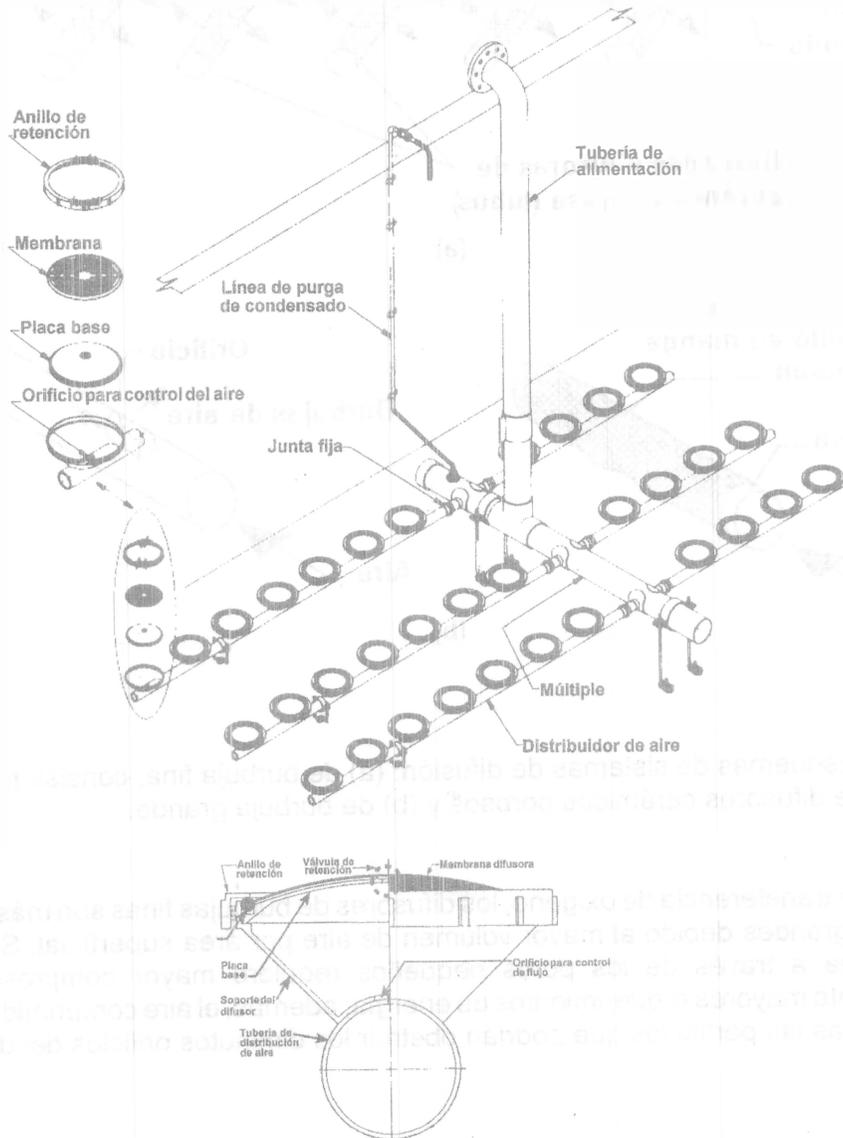
Los difusores de burbujas grandes ofrecen como ventajas menor mantenimiento y baja pérdida de carga, pero tienen una pobre eficiencia en la transferencia de oxígeno. Una forma de mejorar su operación es instalando una turbina mecánica justo encima del difusor de burbujas grandes de tal forma que la acción de las hojas a alta velocidad rotacional fracciona las burbujas grandes en pequeñas y las dispersa a través del líquido. La Figura 14.13 muestra instalaciones típicas de sistemas de aire.
