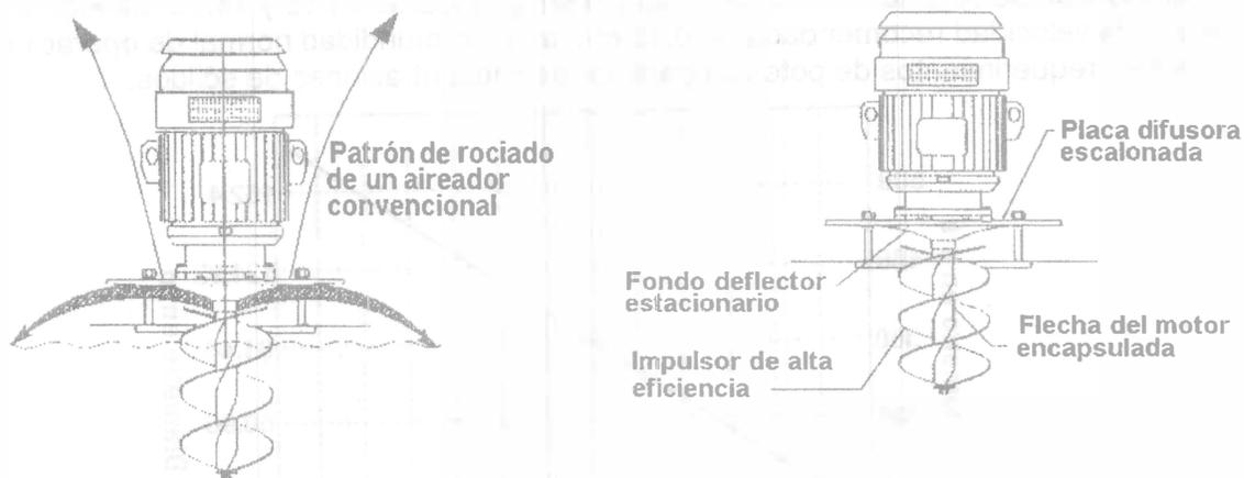
Figura 14.19. Izquierda: patrón de rociado convencional y mejorado (flechas inferiores) de un aireador mecánico. Derecha: elementos principales de un aireador mecánico (AIRE-O<sub>2</sub>TURBO, AEREATION INDUSTRIESINTERNATIONAL, INC.).
