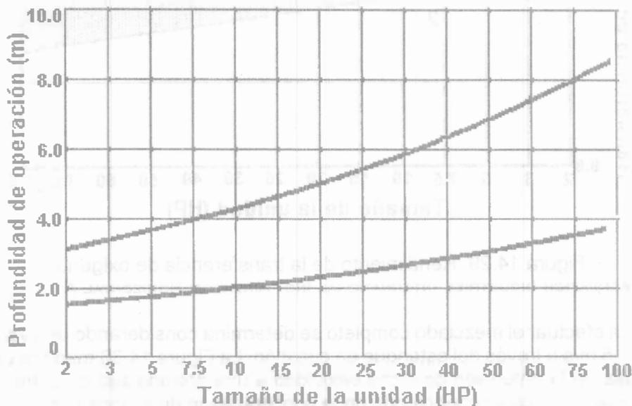
Figura 14.31. Profundidad de operación mínima y máxima
