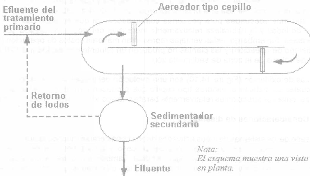
Figura 14.10. Zanja de oxidación
