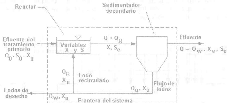
Figura 14.3. Sistema típico de lodos activados con reactor de flujo pistón.
