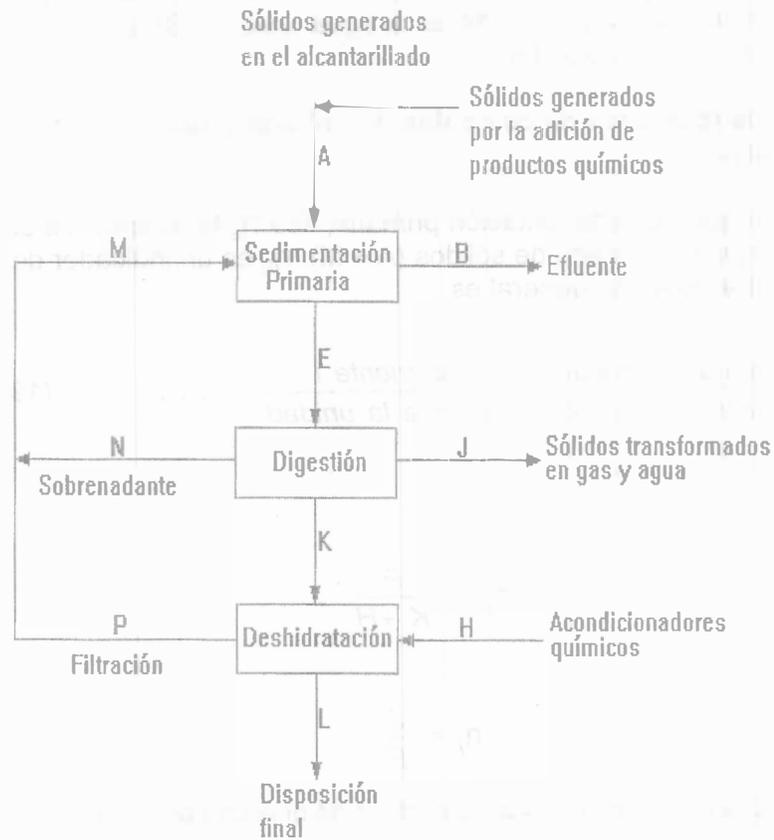
Figura 19.1. Diagrama de flujo de una planta de tratamiento
