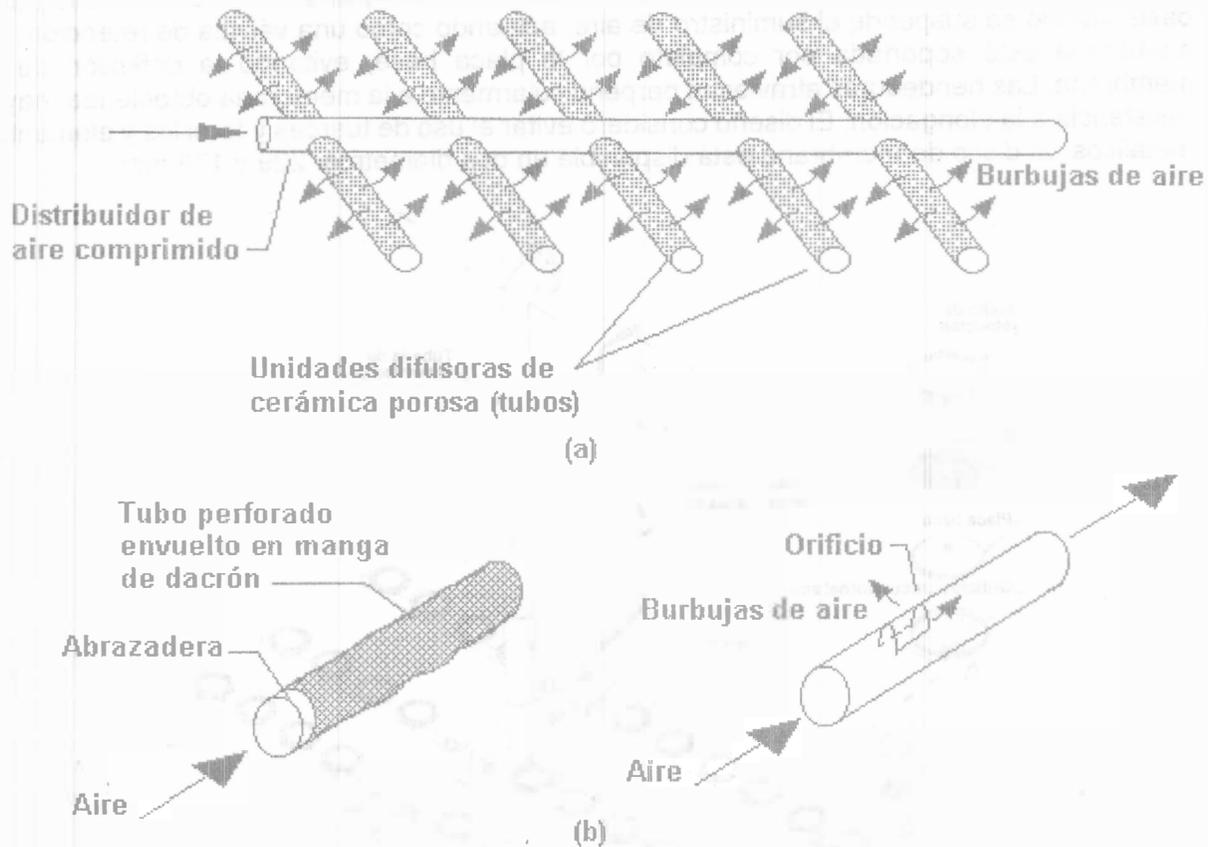
Figura 14.2. Esquemas de sistemas de difusión: (a) de burbuja fina, consistente en una serie de difusores cerámicos porosos y (b) de burbuja grande.
