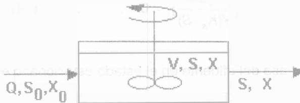
Figura 14.1. Reactor completamente mezclados sin recirculación de lodos.
