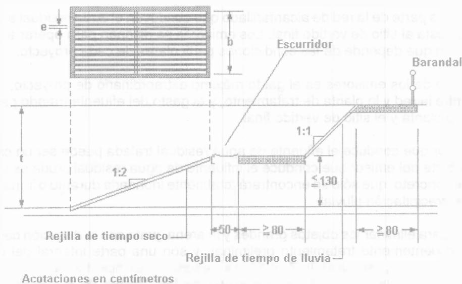
Figura 7.1. Disposición de las rejillas de limpieza manual.
