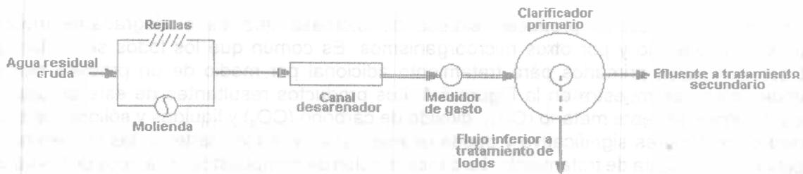
Figura 5.2. Sistema de tratamiento primario típico
