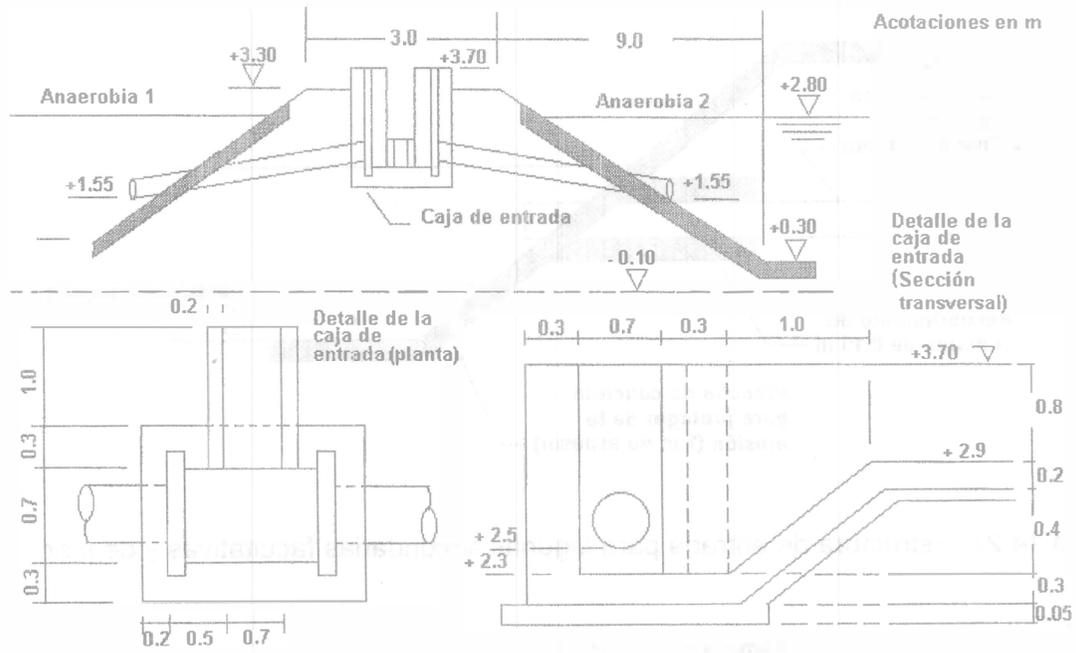
Figura 14.25. Estructura de entrada a laguna anaerobia.
