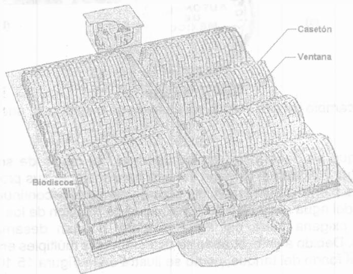
Figura 15.11. Configuración típica de una planta con biodiscos.
