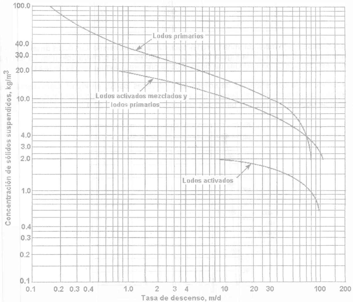
Figura 20.3. Curvas de sedimentación batch.
