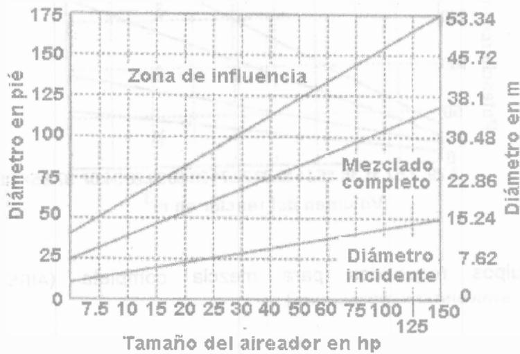
Figura 14.16. Diámetro de las zonas incidente, de mezcla completa y de influencia (AIRE-O<sub>2</sub>TURBO, AEREATION INDUSTRIES INTERNATIONAL, INC.)
