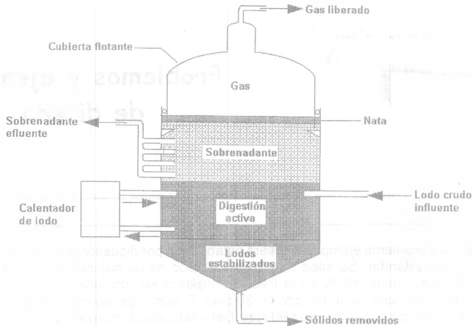
Figura 21.2. Esquema de un digester anaerobio de tasa estándar.
