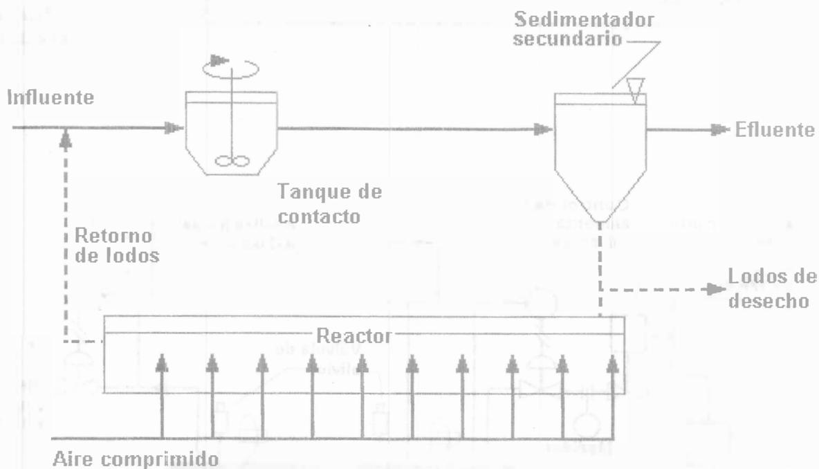
Figura 14.6. Estabilización por contacto.
