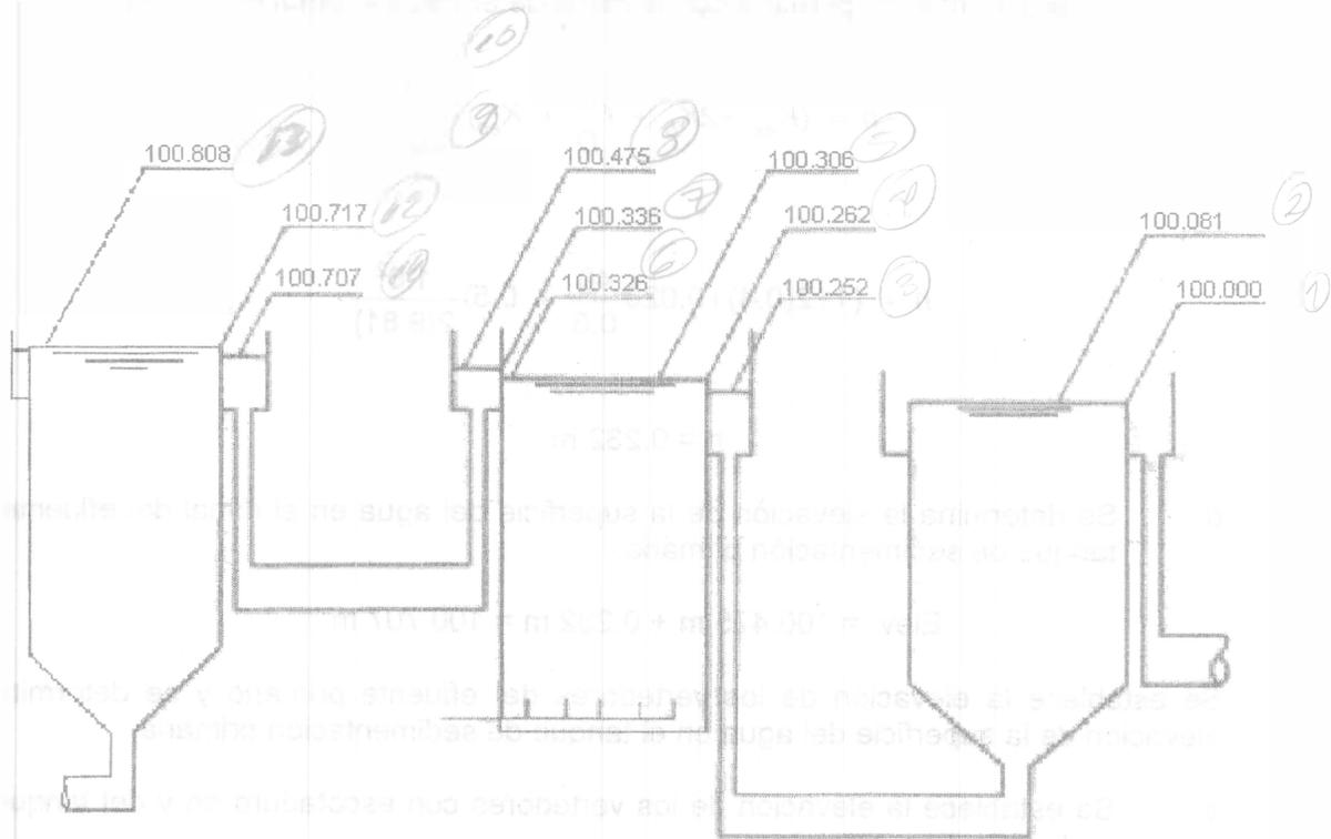
Figura 18.2. Perfil hidráulico del problema ejemplo 18.1
