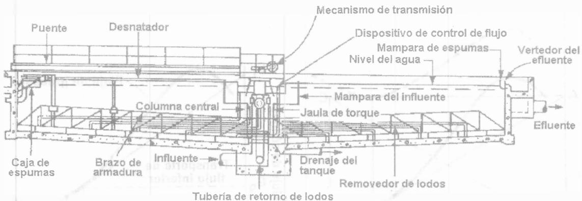
Figura 16.6. Sección transversal de un tanque sedimentador secundario
