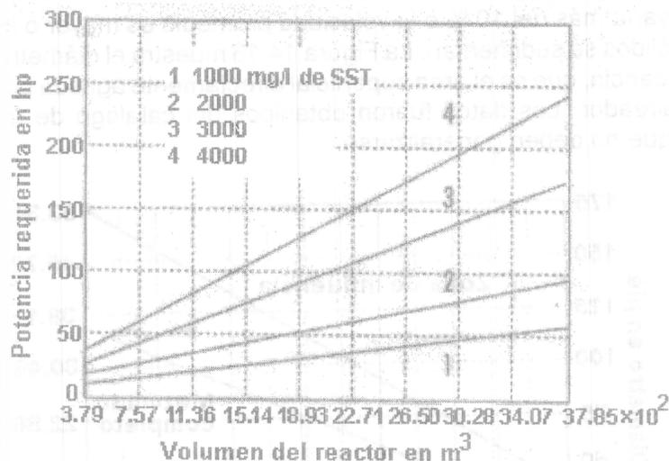
Figura 14.18. Equipos requeridos para mezcla completa (AIRE-O<sub>2</sub>TURBO, AEREATION INDUSTRIESINTERNATIONAL, INC.).
