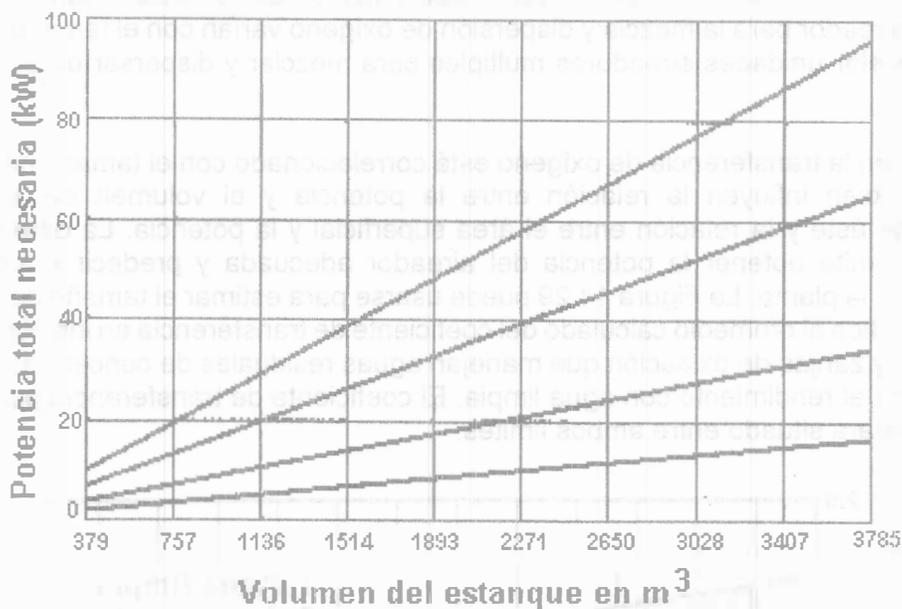
Figura 14.30. Potencia de mezcla completa
