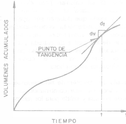
Figura 7.16. La pendiente de la tangente en un instante de la curva masa representa el gasto en ese instante.
