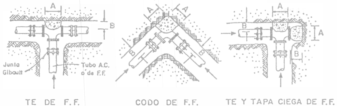
Figura 8.7. Dirección de los empujes y forma de colocar los atraques.
