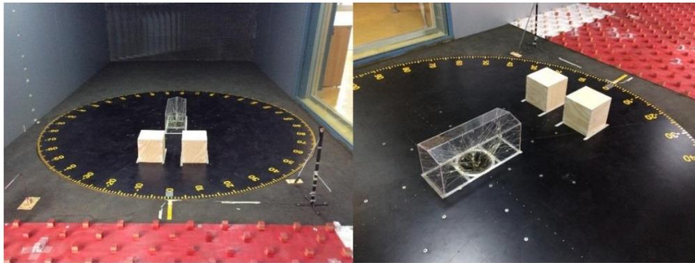
Figura 6.26. Arreglo B con una separación de 40 cm (2 H)
