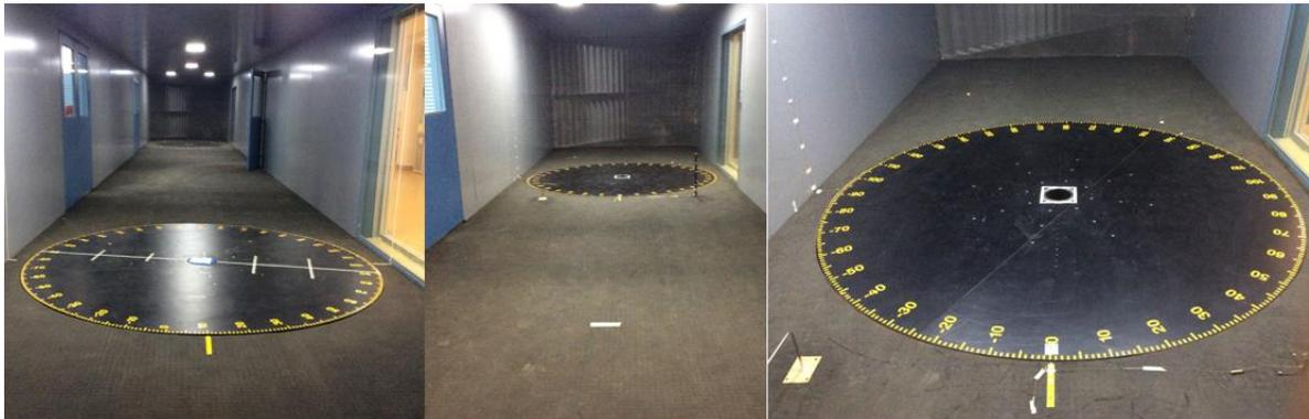
**Figura 4.11. Vista de la mesa giratoria 2 al fondo la sección para modelar la capa límite**
