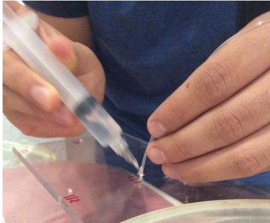
*Figura 5.4. Instrumentación del muro lateral del modelo de la Nave Industrial.*
