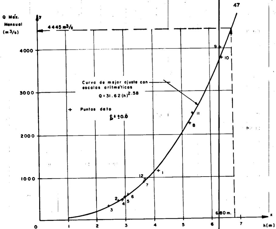
Fig. 8.6 Curva de mejor ajuste obtenida para relacionar los gastos máximos mensuales en el Río Mezcalapa y las lecturas correspondientes en la escala de referencia. Curva Elevaciones - Gastos de la Estación Hidrométrica Las Peñitas.
