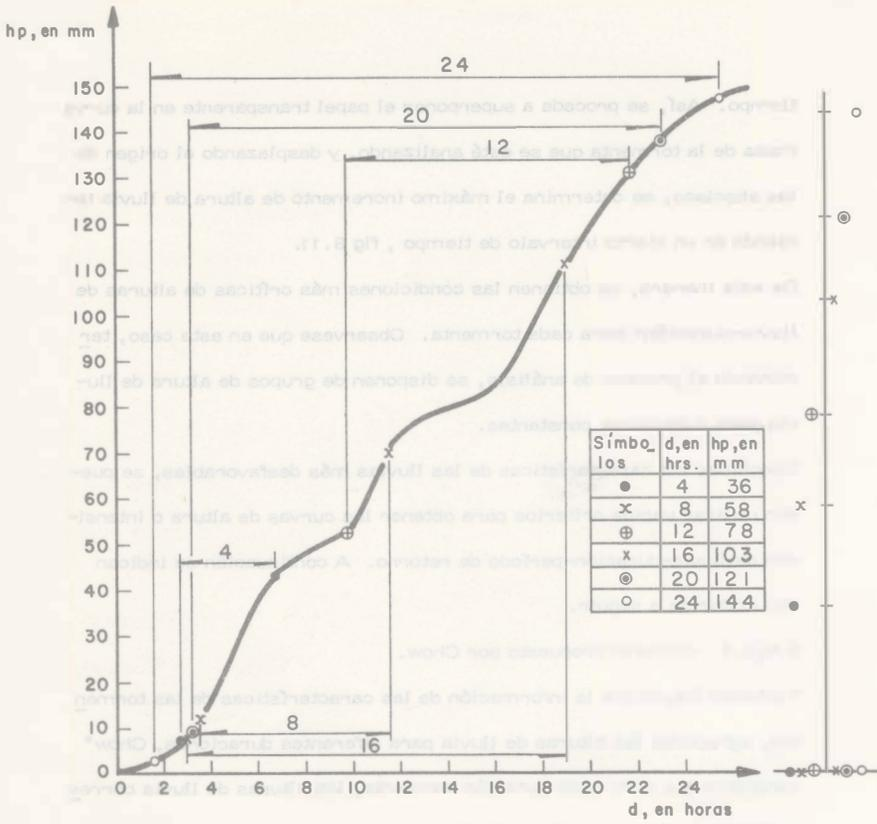
Fig.8.II Análisis de una curva masa para obtener las máximas variaciones de altura de lluvia en relación con diversos intervalos de duración de la misma
